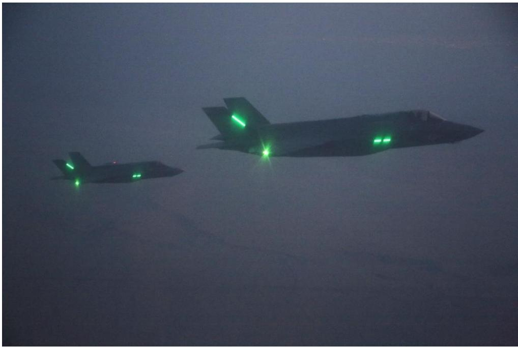
Slika 8. Formacijska svjetla na zrakoplovu F-35 [23]
