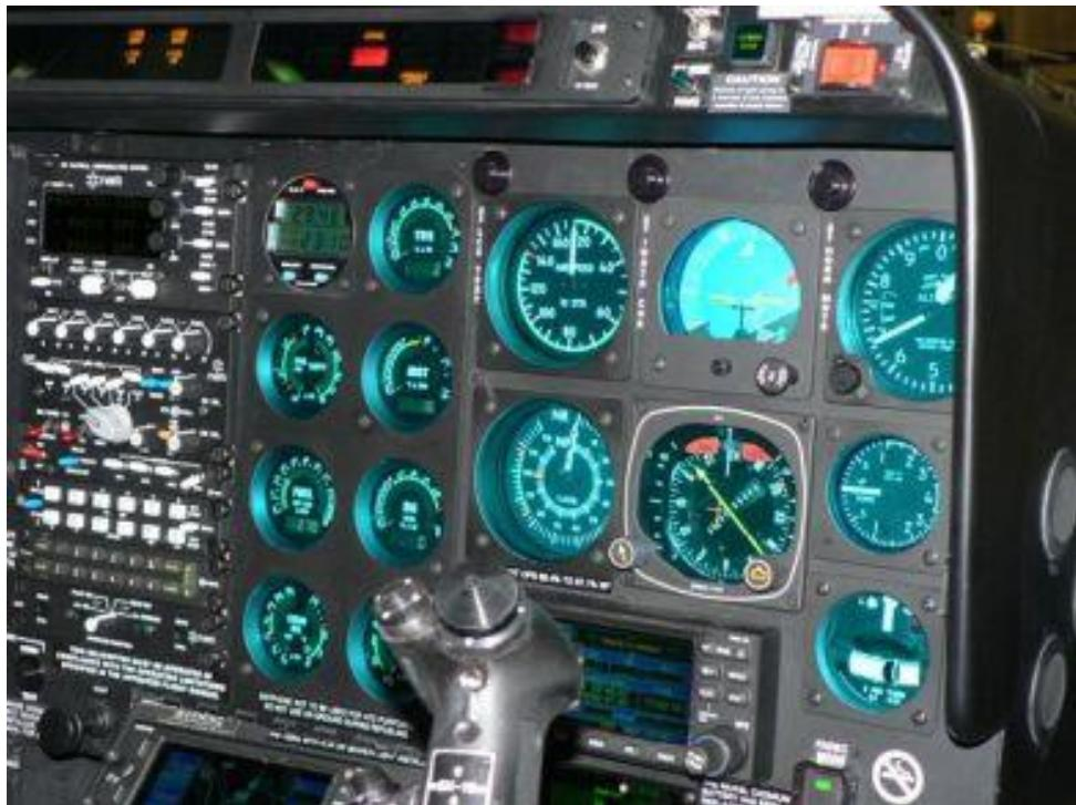
Slika 10. Kokpit zrakoplova opremljen filtrima svjetla.[13]
