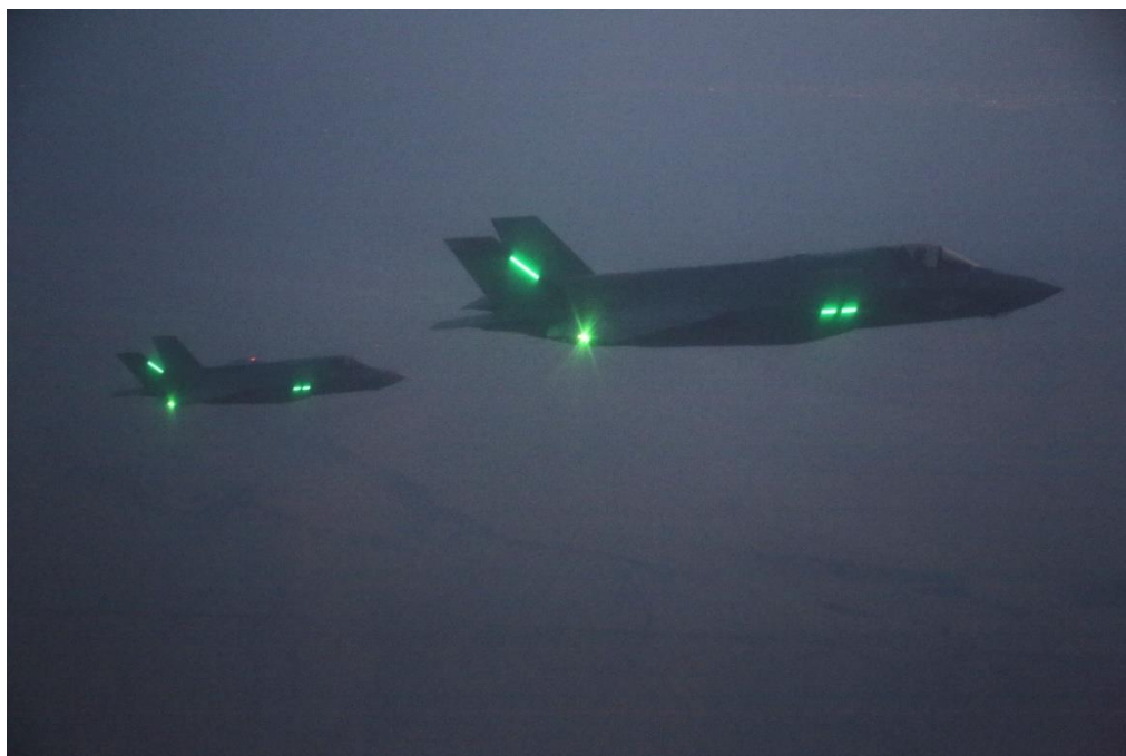
Slika 8. Formacijska svjetla na zrakoplovu F-35 [23]
