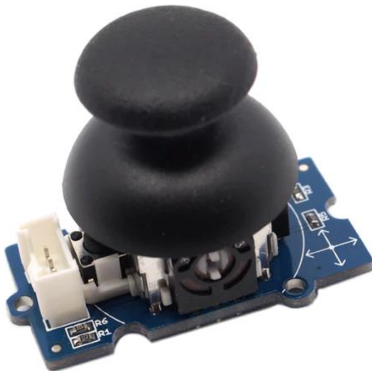
Slika 20. Arduino Groove thumb joystick [11]
