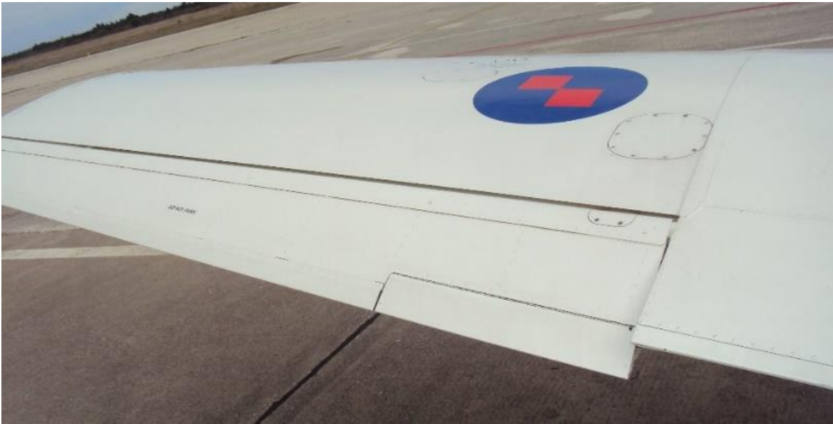
Slika 7. Krilca na zrakoplovu Pilatus PC-9M [2]
