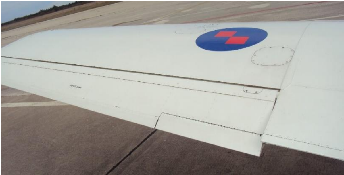
Slika 7. Krilca na zrakoplovu Pilatus PC-9M [2]
