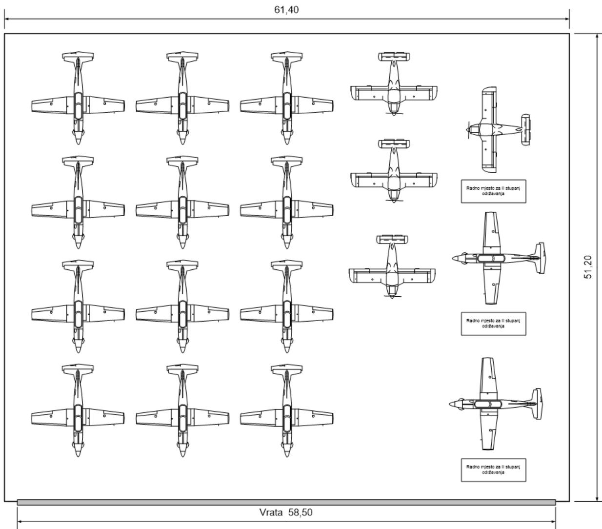
Slika 6. Hangar 392. EA sa shemom parkiranja zrakoplova PC-9M i Zlin 242L i radnih mjesta za održavanje u II. Stupnju [1]
