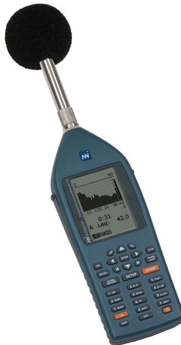
Slika 10. Zvukomjer Norsonic Nor140 [19]
