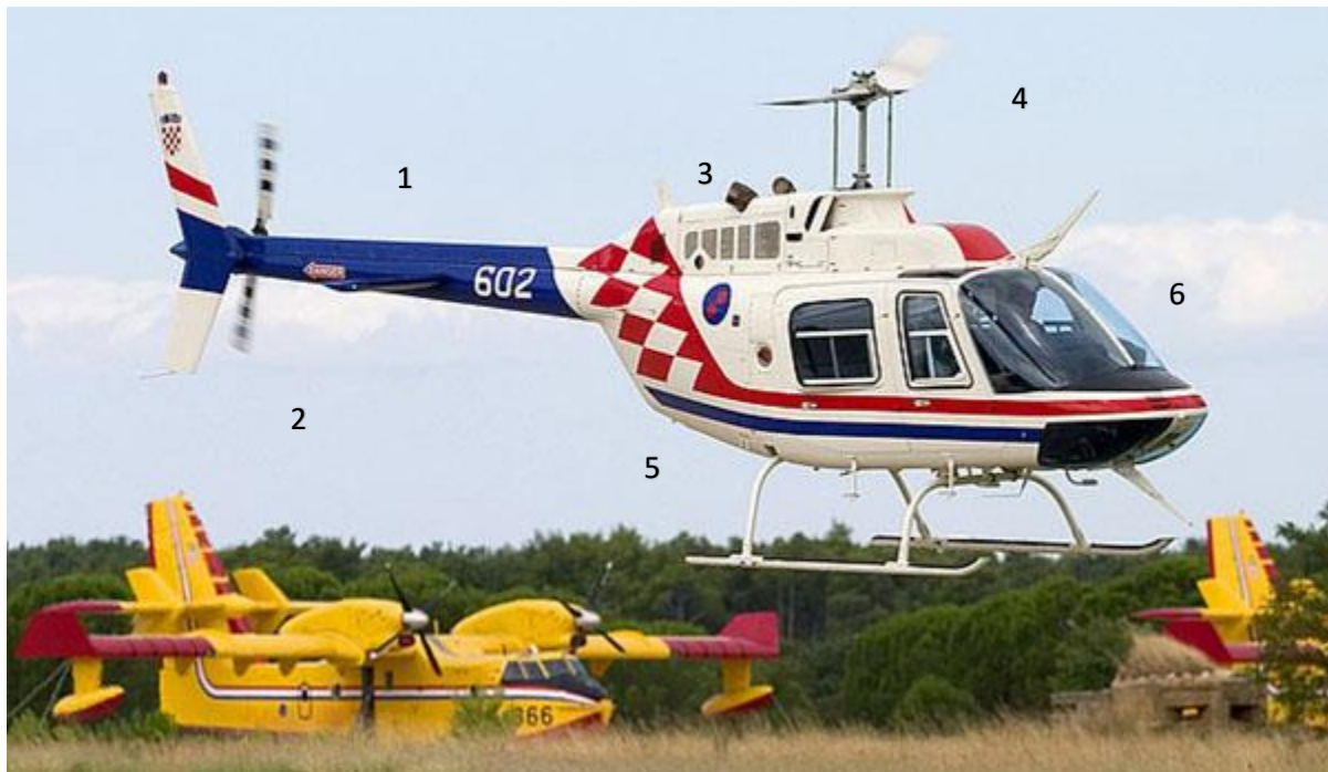
Slika 2. Izvori buke na helikopteru Bell 206B: 1) buka interakcije glavnog repnog rotora; 2) buka repnog rotora; 3) buka motora; 4) visokofrekventna širokopojasna buka glavnog rotora; 5) visokobrzinska impulsna buka; 6) aerodinamička buka
