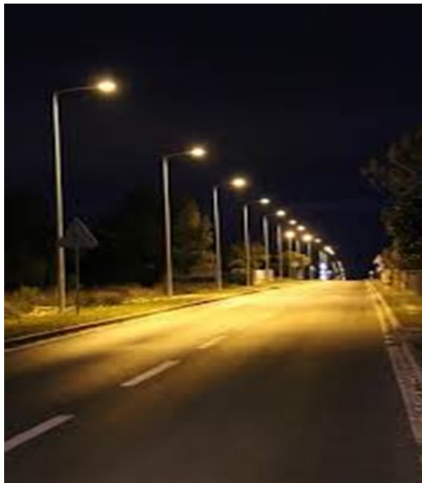
Slika 13. Jednostrani raspored izvora svjetlosti
