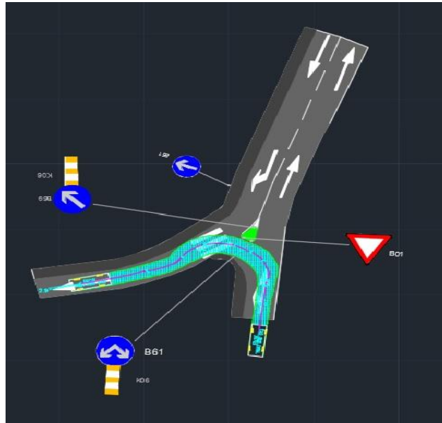
Slika 40. Trajektorija osobnog automobila
