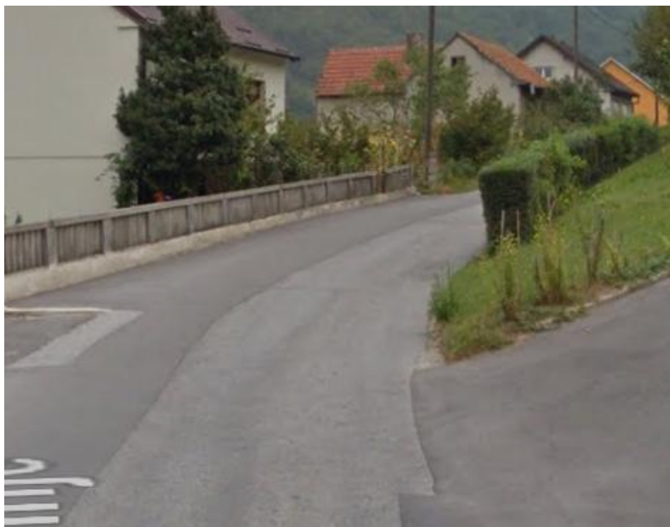
Slika 29. Nepregledan zavoj, kolnik nedovoljne širine
