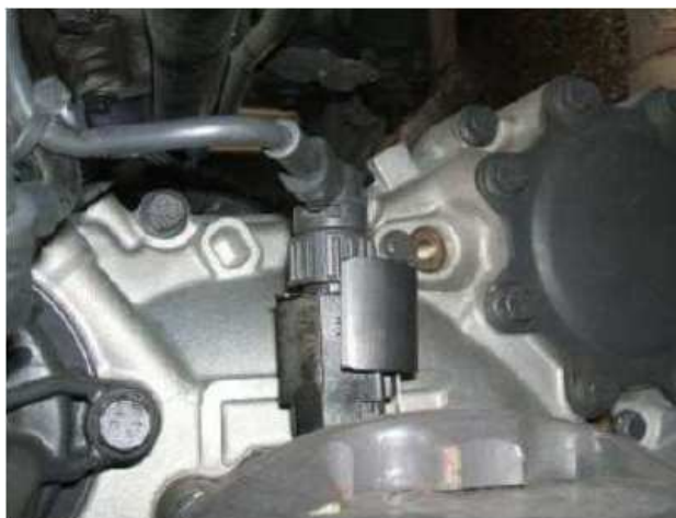
Slika 24 Magnet postavljen na senzoru tahografa koji se nalazi na mjenjaču
