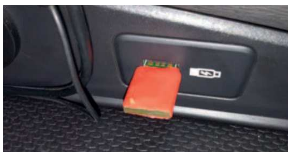
Slika 28. Uređaj za manipulaciju radom tahografa spojen na USB priključak
