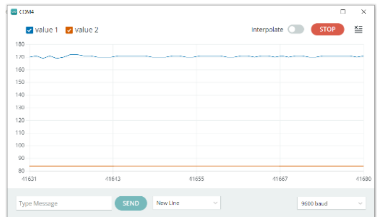
Slika 28 Izlazne vrijednosti kad je senzor nagnut unazad
