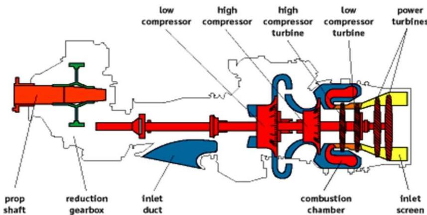
Slika 22. - Shema motora PW100[19]
