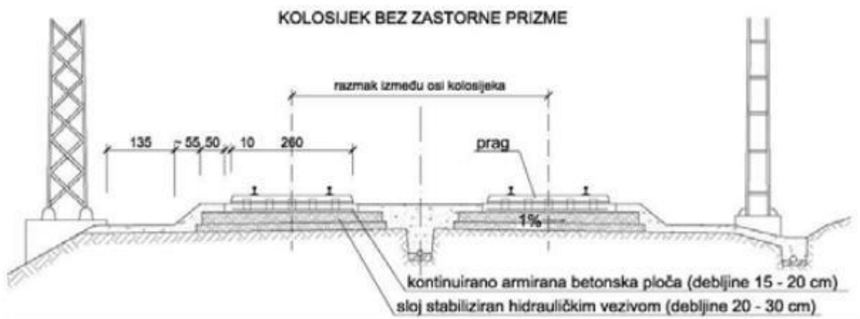
Slika 3. Poprečni presjek kolosijeka bez kolosiječnog zastora
