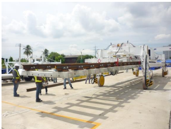
Slika 6. Vozilo za polaganje kolosijeka
