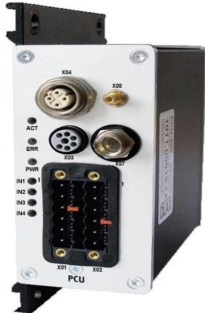
*Slika 3. Centralna jedinica napajanja i obrade podataka.*
