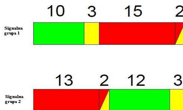
Slika 30. Signalni plan predloženog stanja raskrižja Ulice K.Filića-M.Krleže
