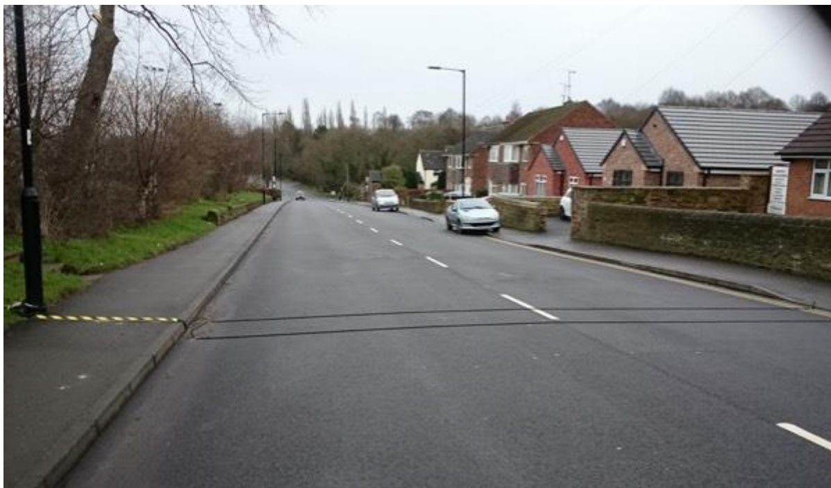
Slika 24. Automatski brojači osovina
