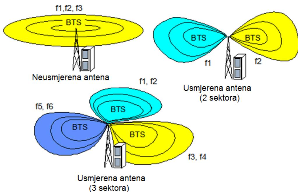
Slika 12. Usmjerena i neusmjereni antena, [2]
