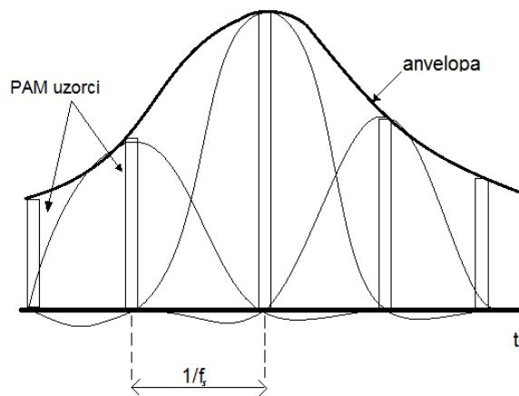
Slika 20. Rekonstrukcija analognog signala na niskopropusnom filtru,
