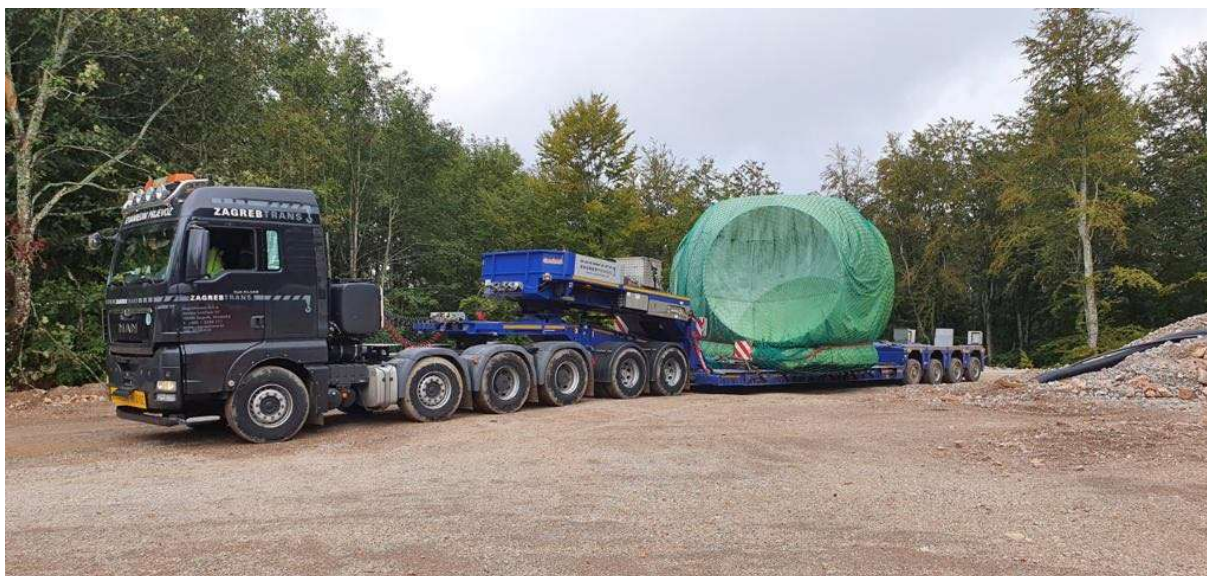
Slika 26. Prikolica natovarena generatorom vjetroelektrane
