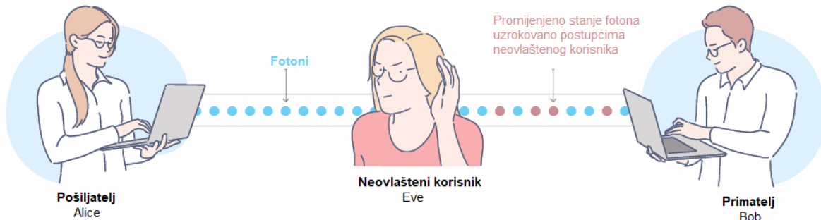
Slika 7. Primjer promjene stanja fotona u slučaju prisluškivanja od strane neovlaštenog korisnika
