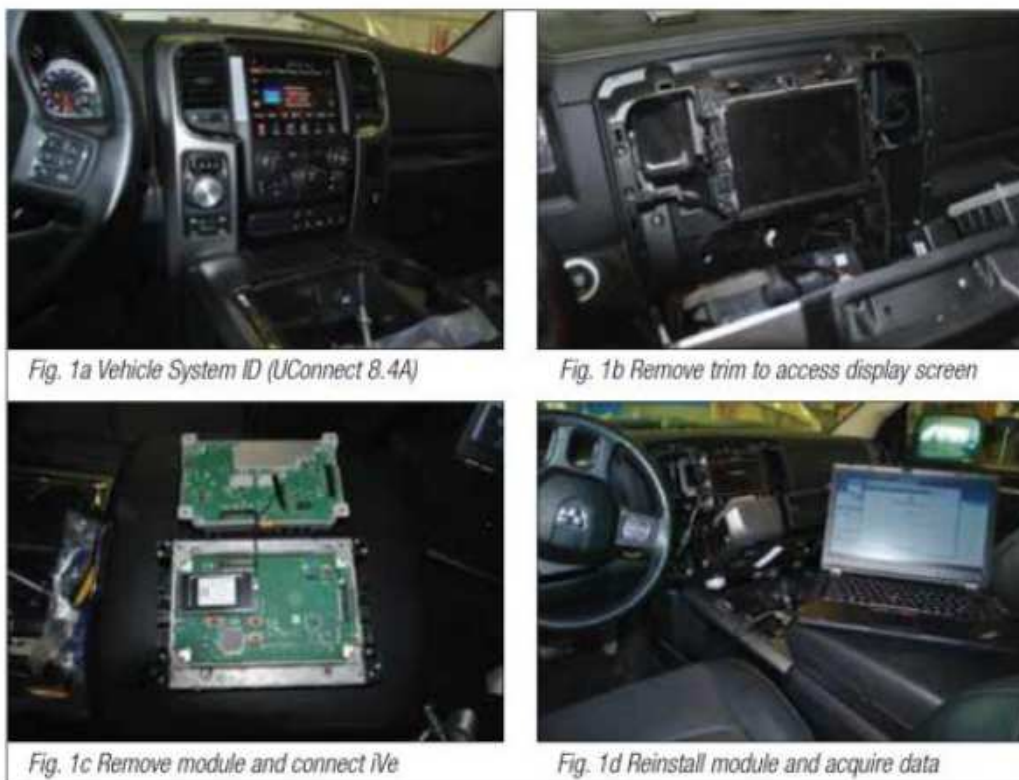
Slika 6.4. Prikupljanje podataka pohranjenih u vozilu[38]
