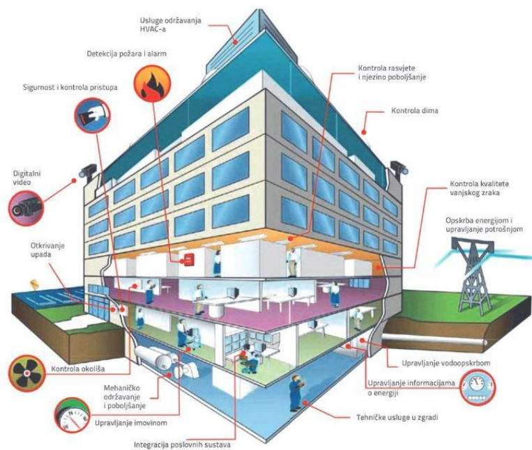
Slika 3. Pametni uslužni sustavi zgrade
