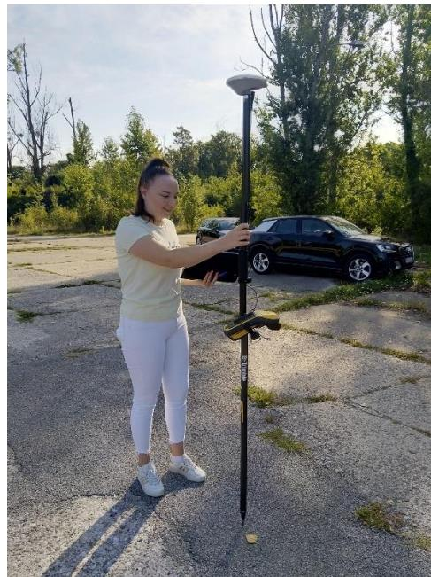
Slika 39. GPS uređaj za pozicioniranje u prostoru montiran na geodetsku šipku - Trimble Geo 7X
