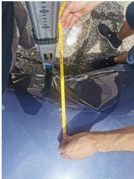
Slika 34. Mjera oštećenja stražnjeg dijela vozila
