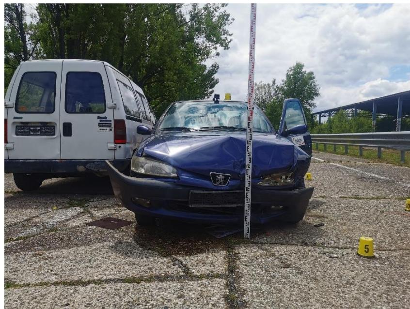
Slika 33. Mjera oštećenja prednjeg dijela automobila Peugeot
