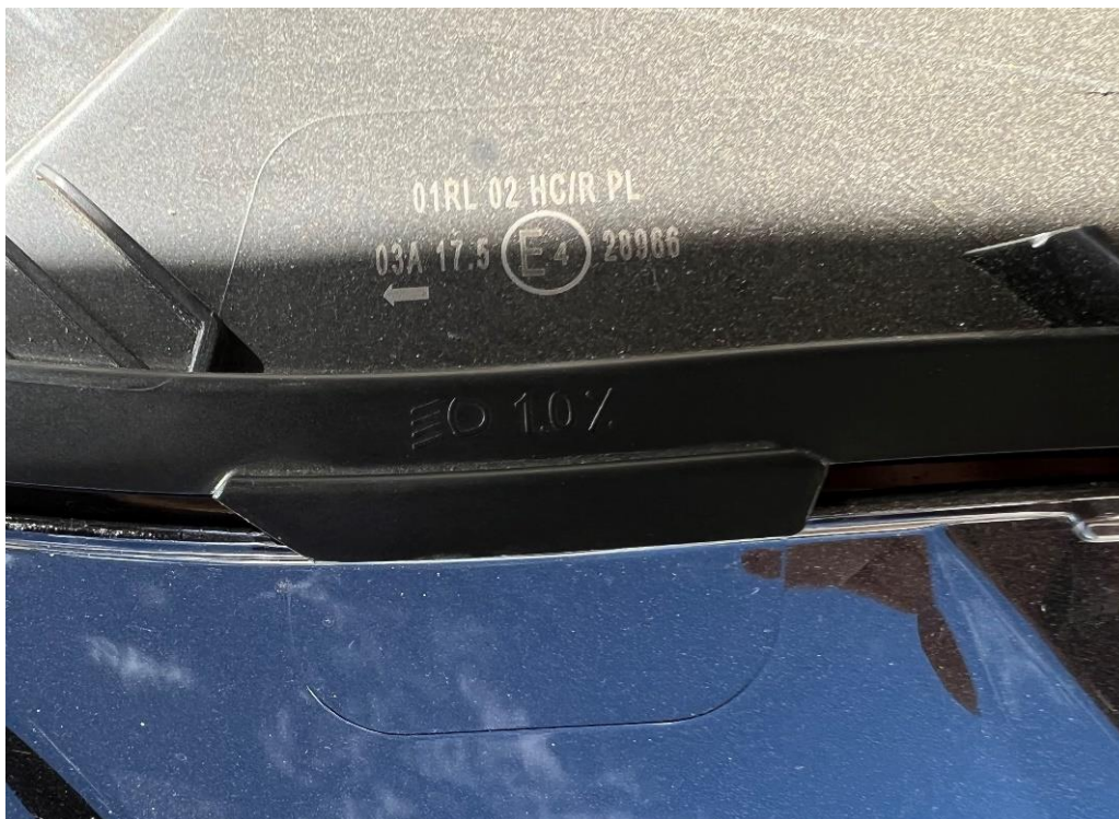
Slika 14. Nagib svjetala koju je odredio proizvođač
