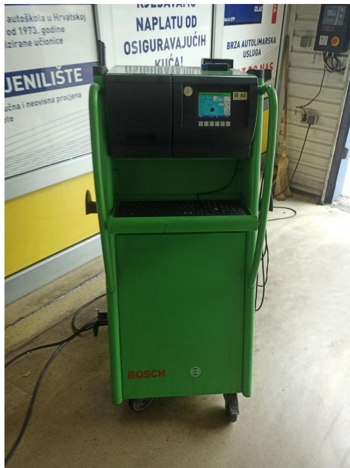
Slika 8. Uređaj za mjerenje zamućenosti ispušnih plinova
