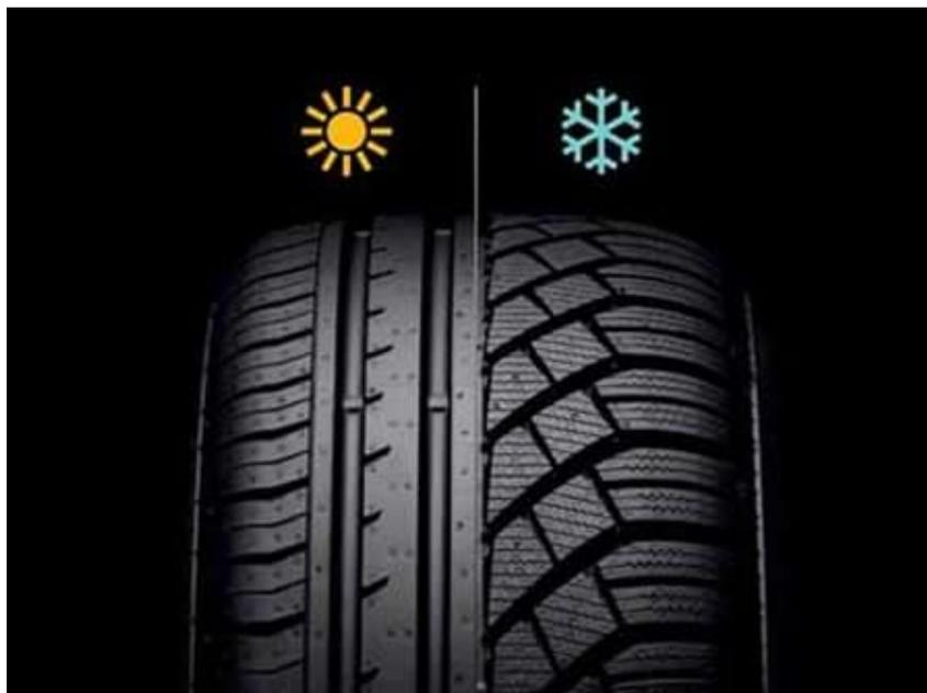
*Slika 2. Ljetni pneumatik (lijevo) i zimski pneumatik (desno)*
