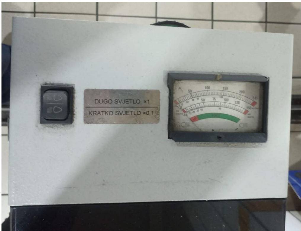
Slika 7. Dio regloskopa za mjerenje jačine svjetlosnog snopa
