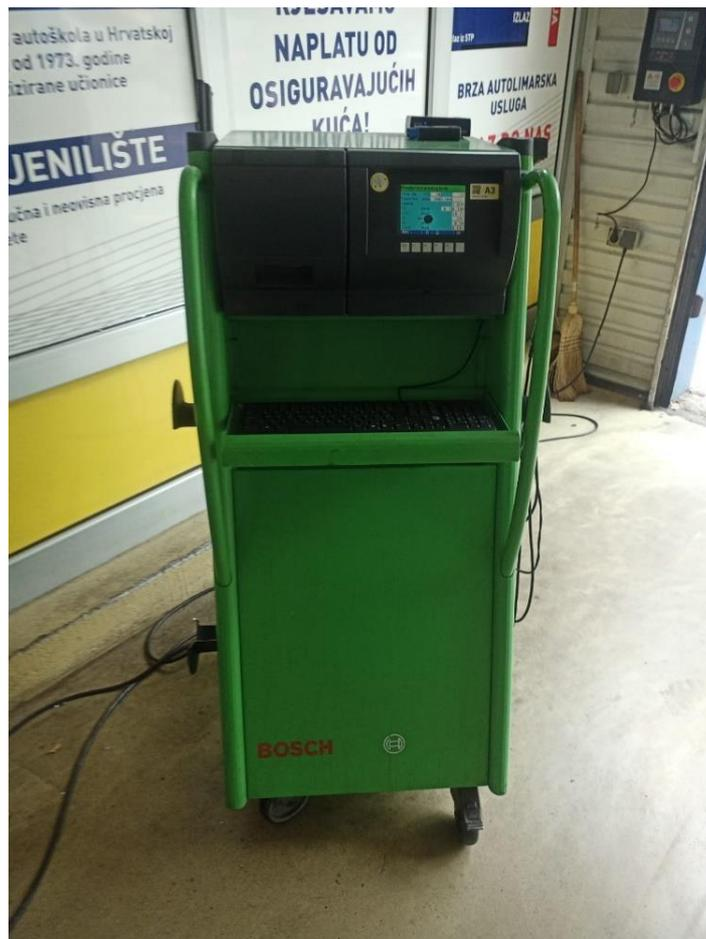
*Slika 8. Uređaj za mjerenje zamućenosti ispušnih plinova*
