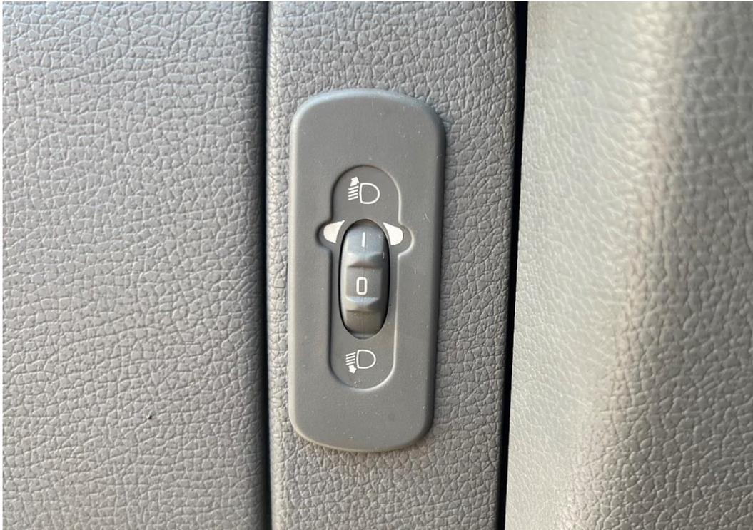
*Slika 15. Uređaj za podešavanje visine svjetala u vozilu*
