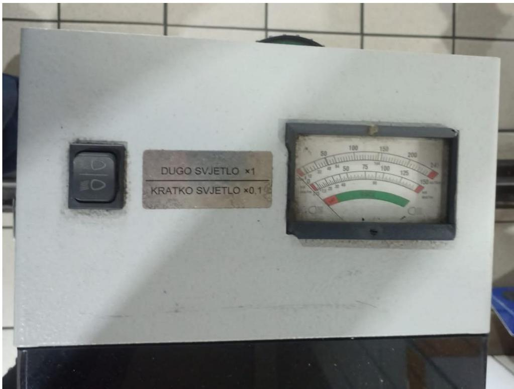
*Slika 7. Dio regloskopa za mjerenje jačine svjetlosnog snopa*
