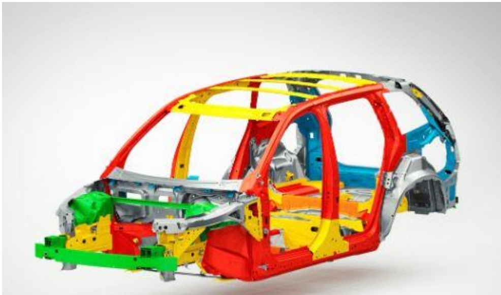
Slika 3. Prikaz različitih materijala karoserije Volvo automobila
