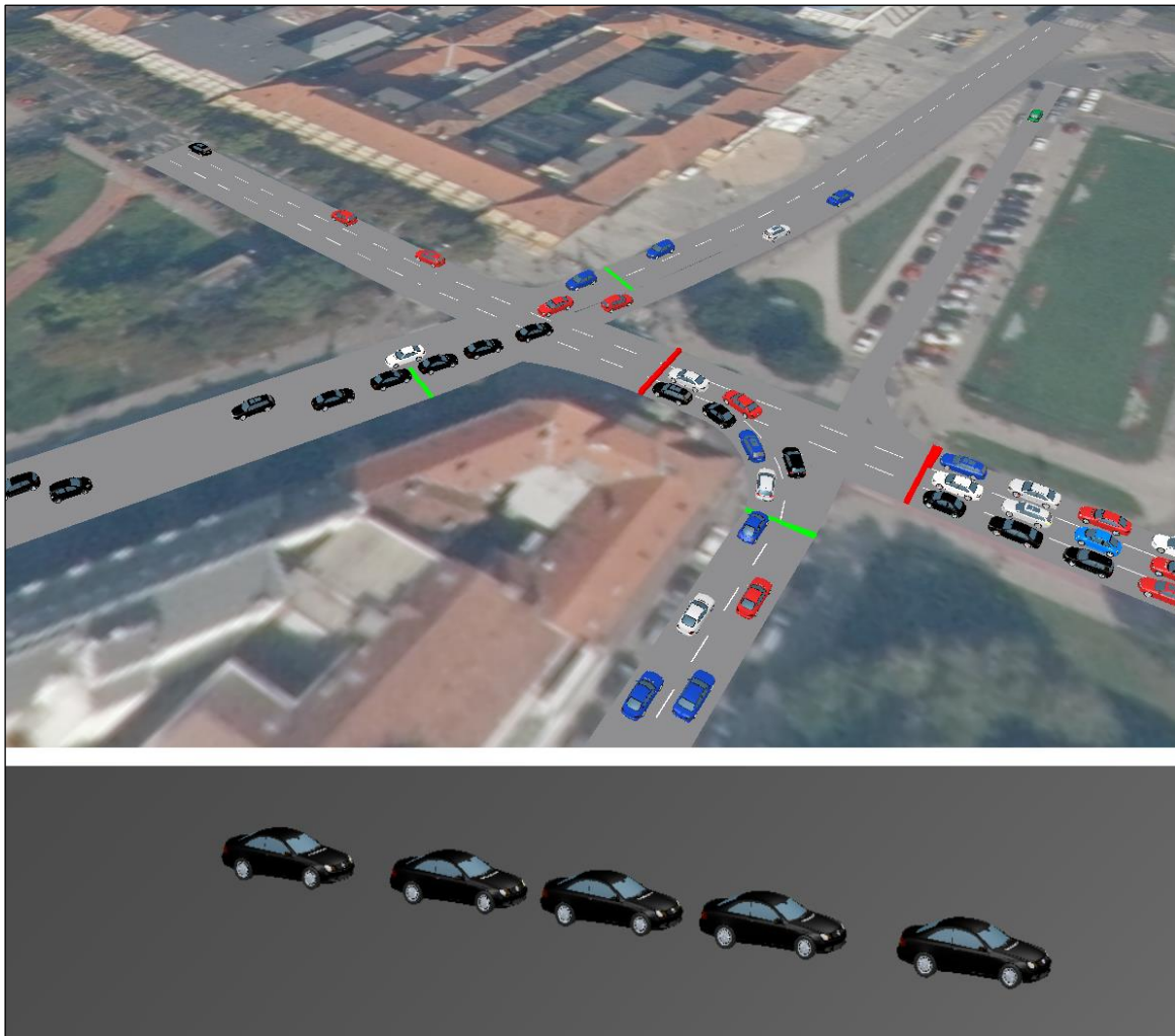
Slika 27. Prikaz prolaska prioritetne kolne (slika gore) i izgled prioritetne kolone napravljene u VISSIM simulacijskom modelu (slika dolje)
