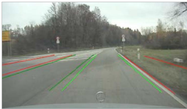
Slika 22. Nepravilno praćenje prometnih traka unutar raskrižja, [29]
