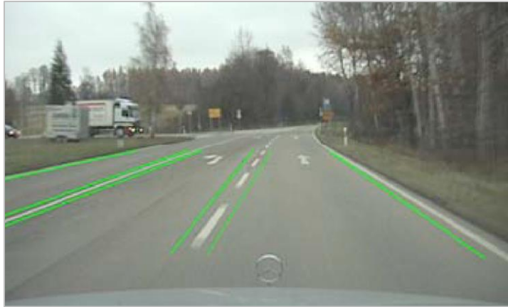
Slika 21. Pravilno praćenje prometnih traka unutar raskrižja, [29]
