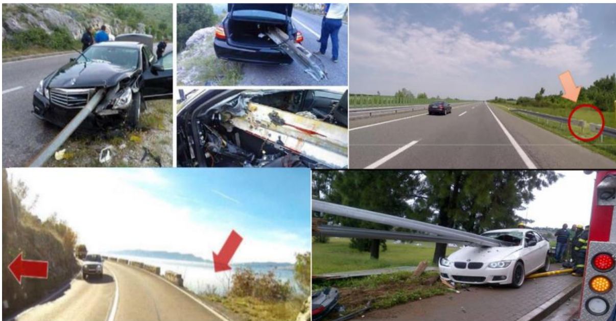
Slika 3. Posljedice neadekvatno postavljene zaštitne ograde
