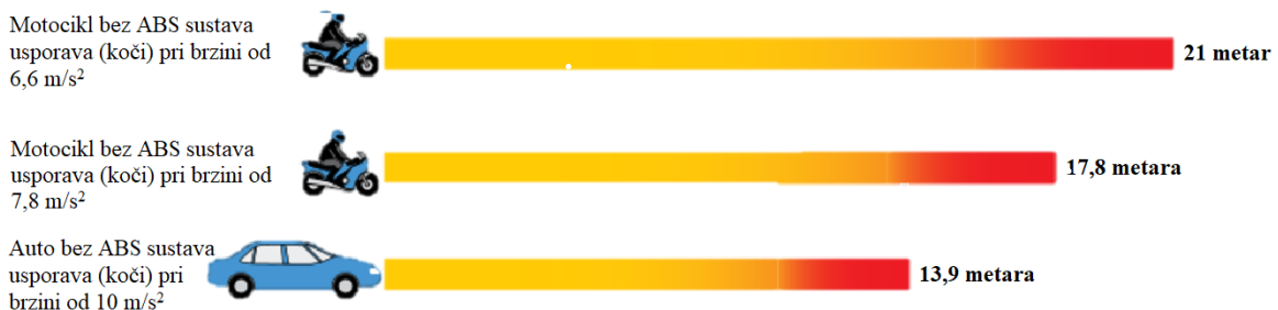
Slika 3. Zaustavni put motocikala i automobila
