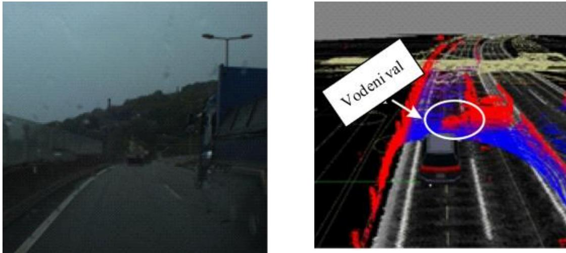
Slika 3: Voden val ispred senzora tijekom kiše
