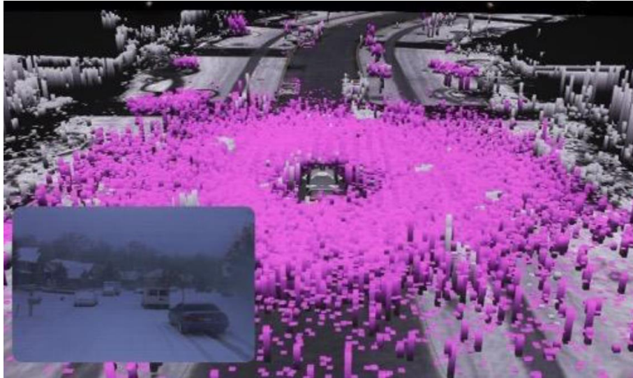
Slika 4: Smetnje za lidar izazvane snijegom
