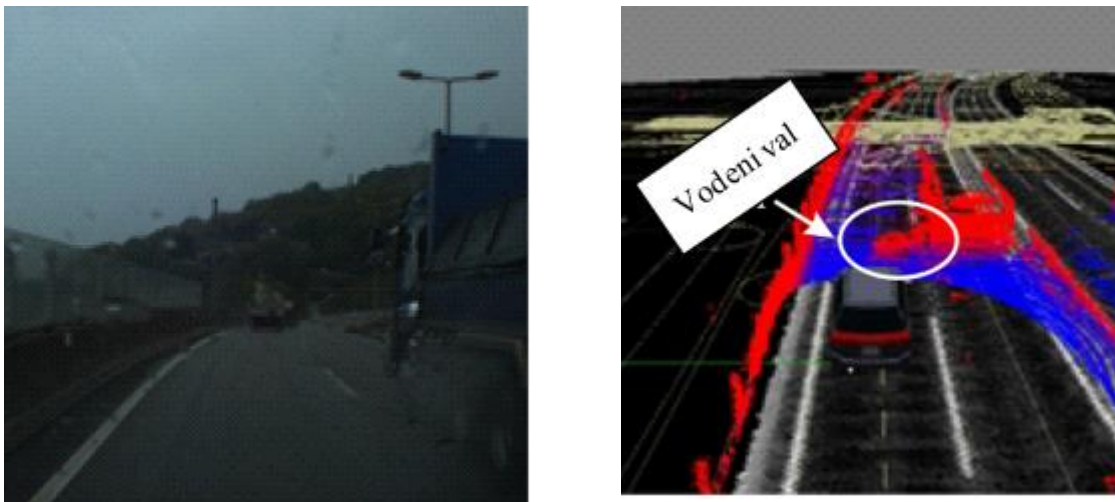
Slika 3: Vodeni val ispred senzora tijekom kiše
