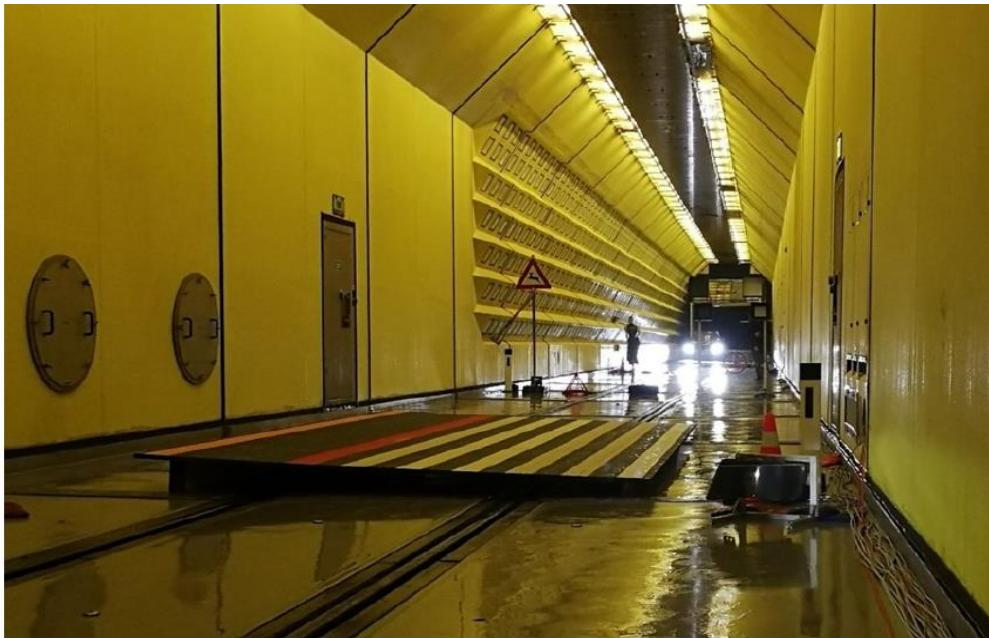
Slika 19: Klimatski zračni tunel s testiranim oznakama
