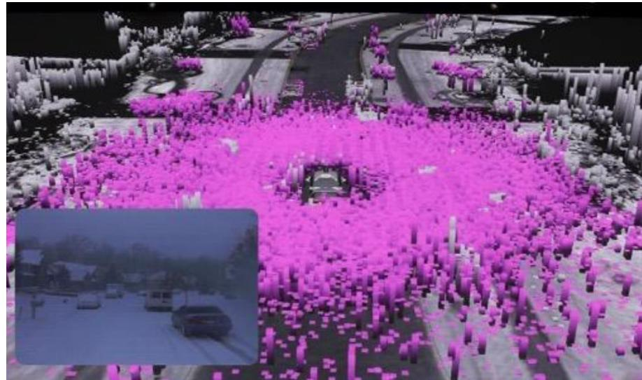
Slika 4: Smetnje za lidar izazvane snijegom
