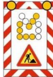
Slika 38. Signalna ploča za označavanje mjesta izvođenja radova na cesti ili oštećenja kolnika (K16) Izvor: [10]
