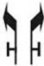
Slika 8. Prestrojavanje na dva bliža križanja gdje se prestrojavanje mora obaviti prije prvoga križanja na koje je zabranjeno skretati u naznačenim smjerovima (H23)
