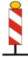
Slika 37. Ploče za obilježavanje mjesta izvođenja radova na cesti ili oštećenja kolnika s treptačem (K15) Izvor: [10]
