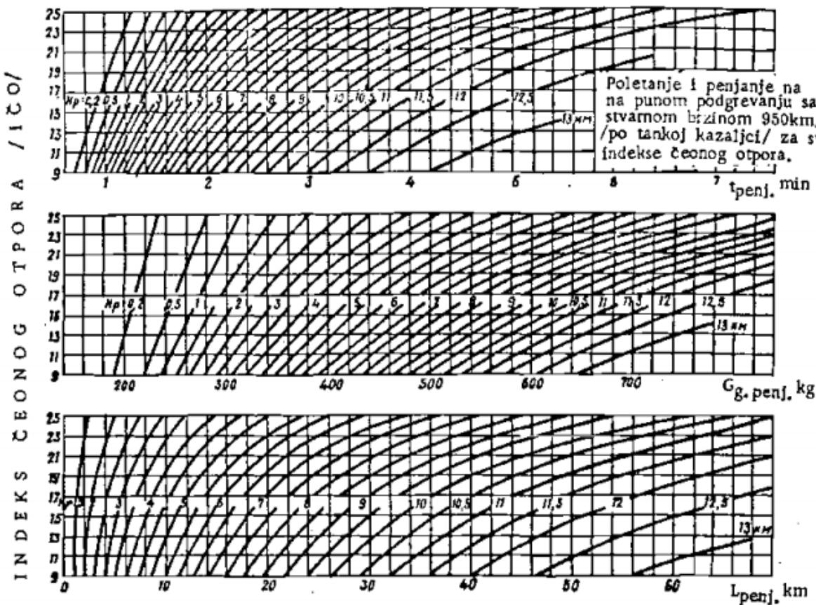
Slika 16. Dijagram za određivanje vremena penjanja, potrošnje goriva kod penjanja i prijeđene udaljenosti pri korištenju naknadnog sagorijevanja
