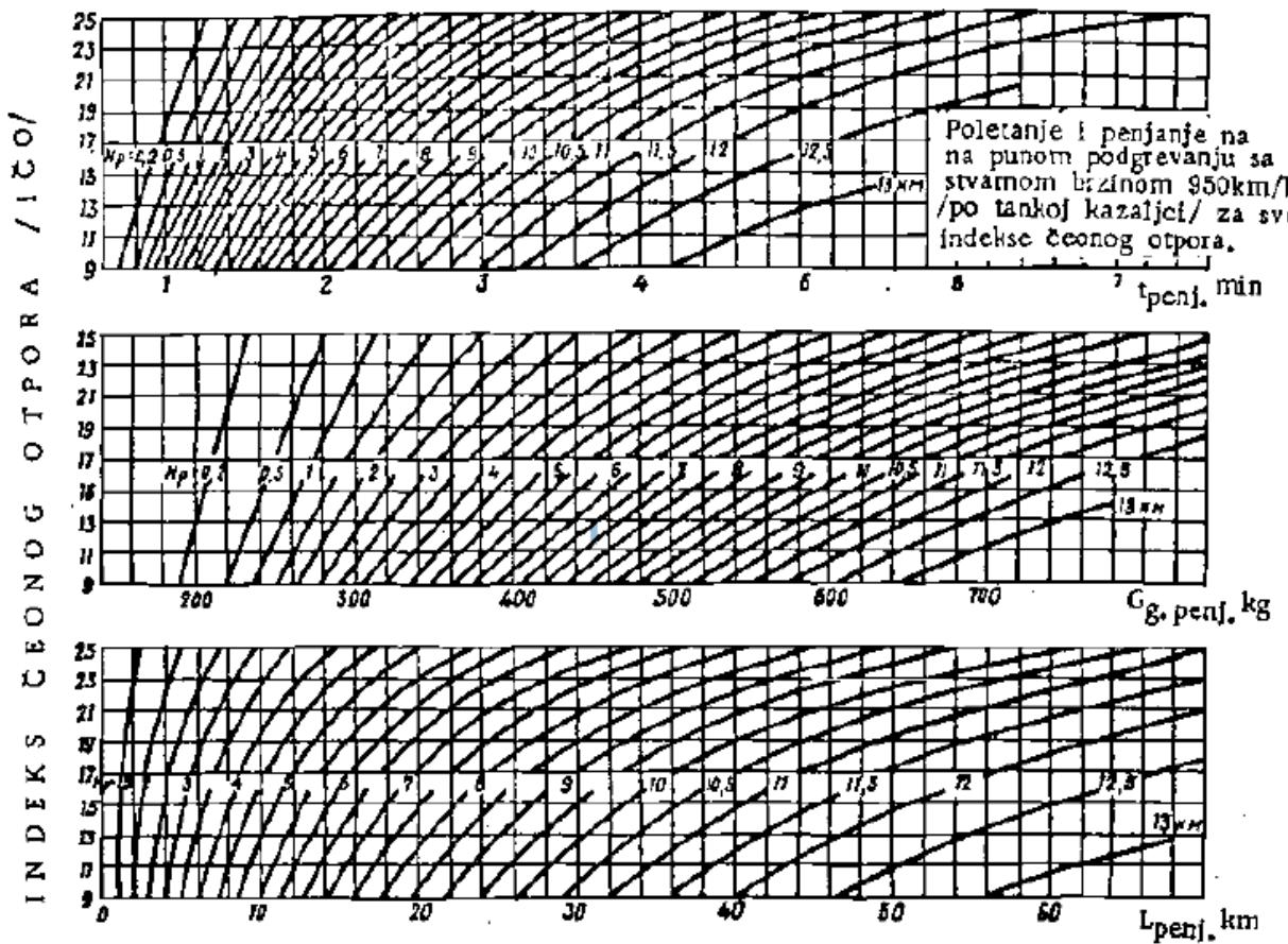
Slika 21. Dijagram za određivanje vremena penjanja, potrošnje goriva kod penjanja i prijeđene udaljenosti pri korištenju naknadnog sagorijevanja
