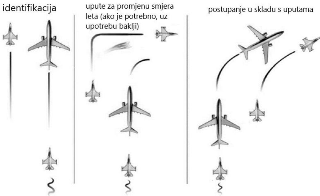
Slika 1. Presretanje s namjerom promjene smjera leta zrakoplova
