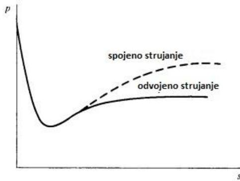
Slika 26. Raspodjela tlaka za spojeno i odvojeno strujanje, [1]
