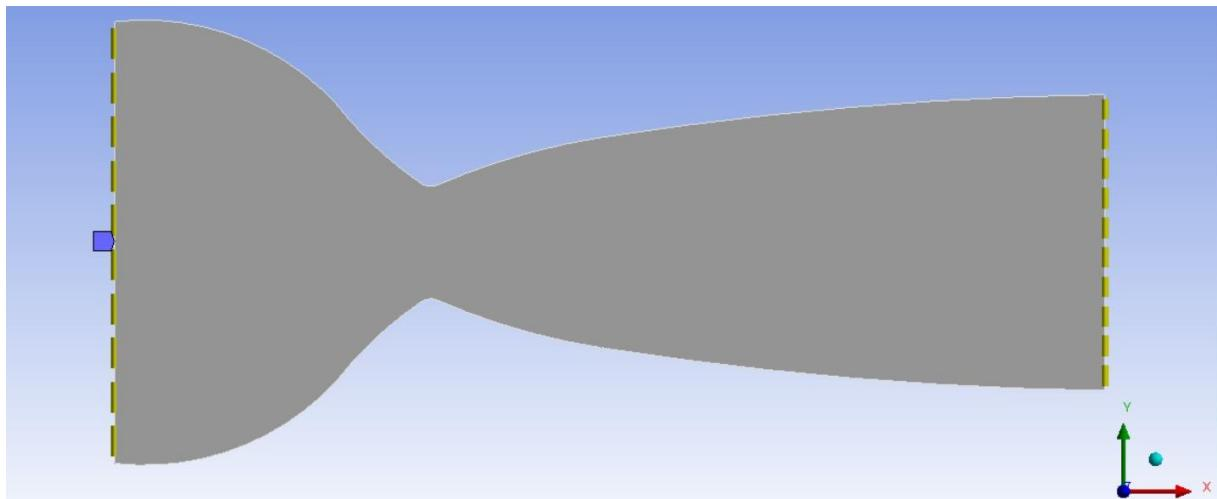
Slika 40. Ulaz i izlaz mlaznice podijeljeni na 10 dijelova, [9]
