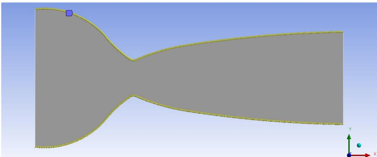
Slika 38. Zidovi mlaznice podijeljeni na 100 dijelova, [9]
