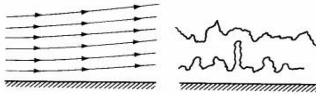
Slika 27. Strujnice laminarnog i turbulentnog strujanja, [1]
