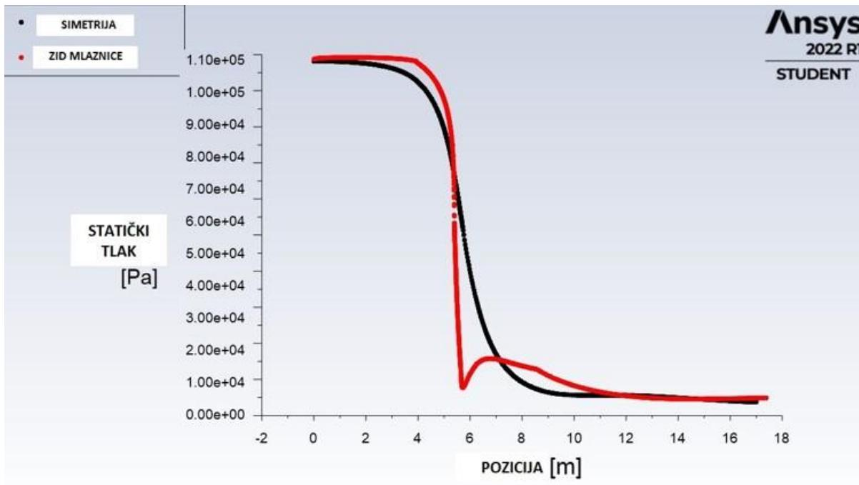
Slika 51. Grafički prikaz raspodijele tlaka na osi simetrije i zidu mlaznice, [9]
