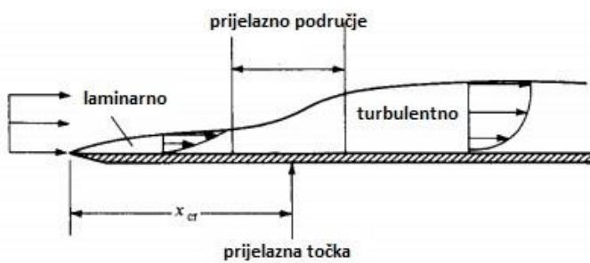
Slika 28. Prijelaz sa laminarnog u turbulentno strujanje, [1]
