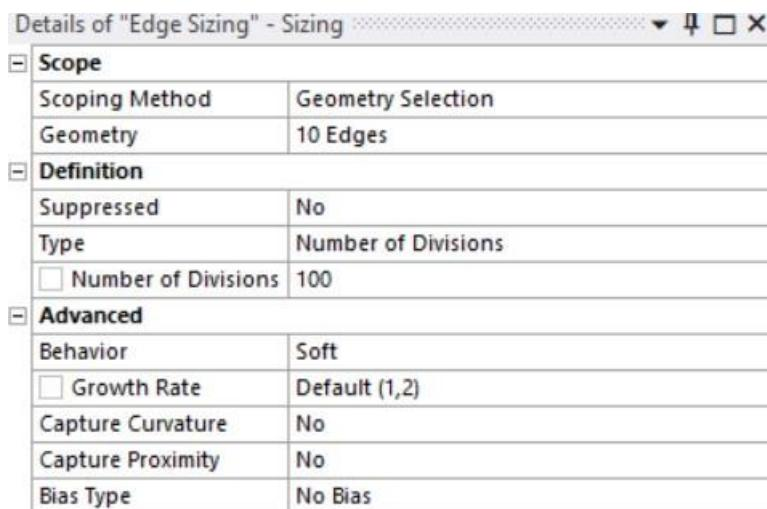
Slika 37. Detalji dimenzioniranja rubova zida mlaznice, [9]
