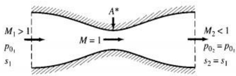
Slika 21. Idealni (izentropski) nadzvučni difuzor, [1]
