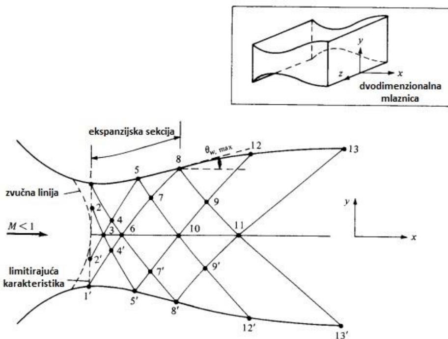
Slika 29. Shematski prikaz dizajna nadzvučne mlaznice metodom karakteristika, [1]
