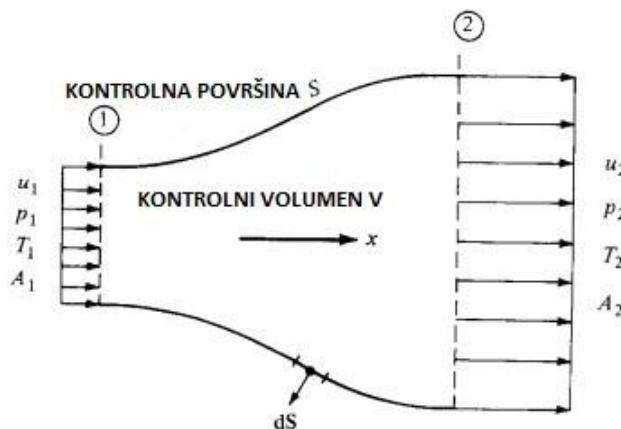
Slika 4. Konačni kontrolni volumen za kvazi-jednodimenzionalno strujanje, [1]
