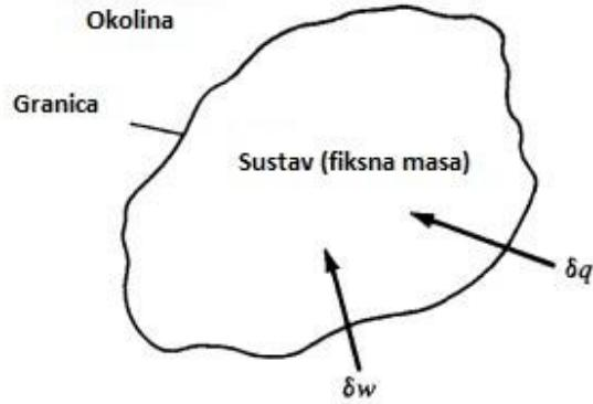
Slika 1. Termodinamički sustav, [1]
