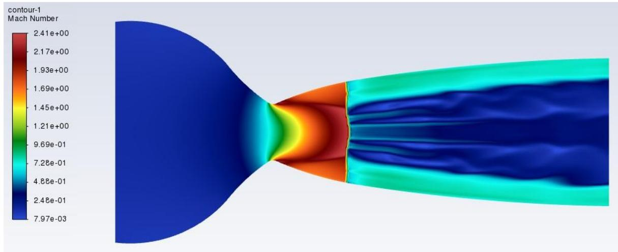
Slika 49. Pojava normalnog udarnog vala unutar mlaznice
