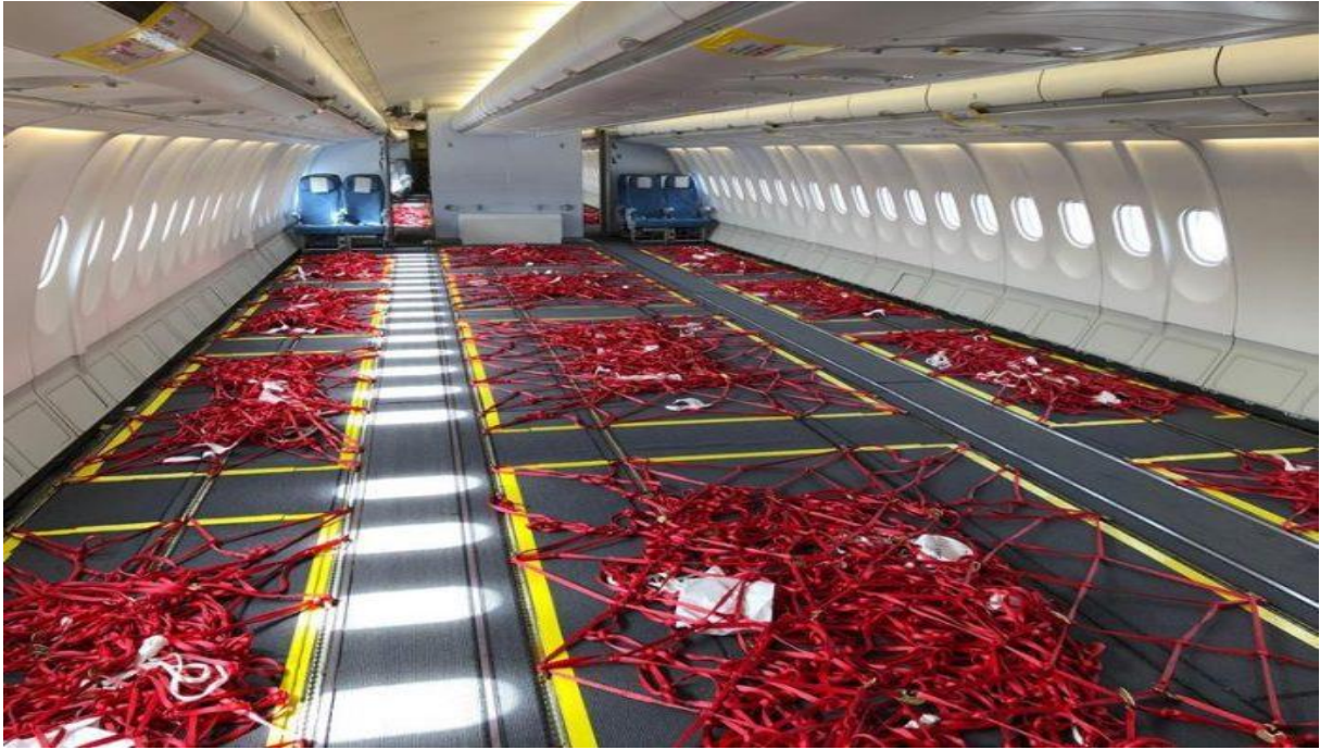
Slika 4. Putnička kabina A330 nakon uklanjanja sjedala, [16]
