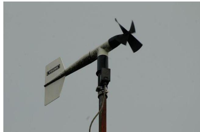
Slika 9 Anemometar sa propelerom [11]
