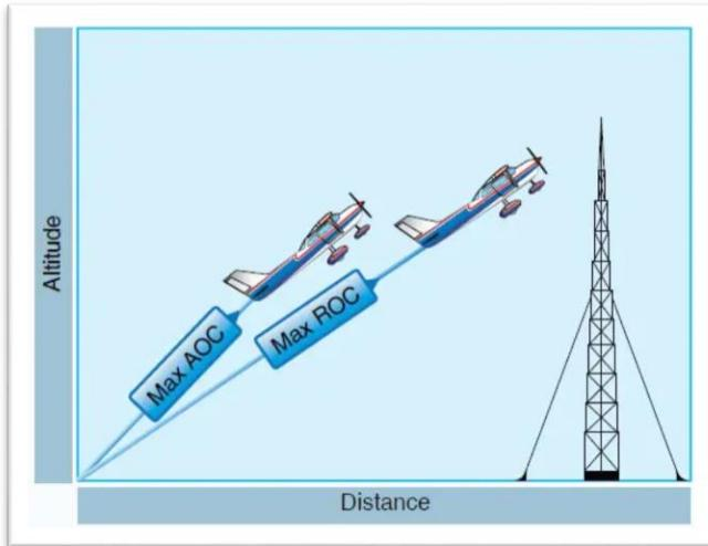
Slika 4 Prikaz BRC i BAC pri povećanoj udaljenosti [5]
