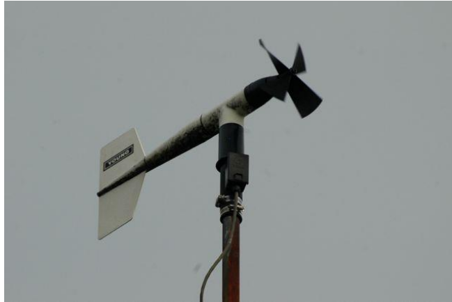
Slika 9 Anemometar sa propelerom [11]
