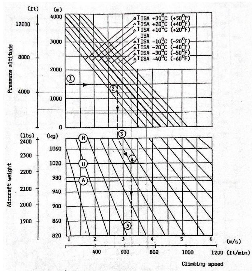
Slika 5 Ovisnost brzine uzdizanja o promjeni visine [1]
