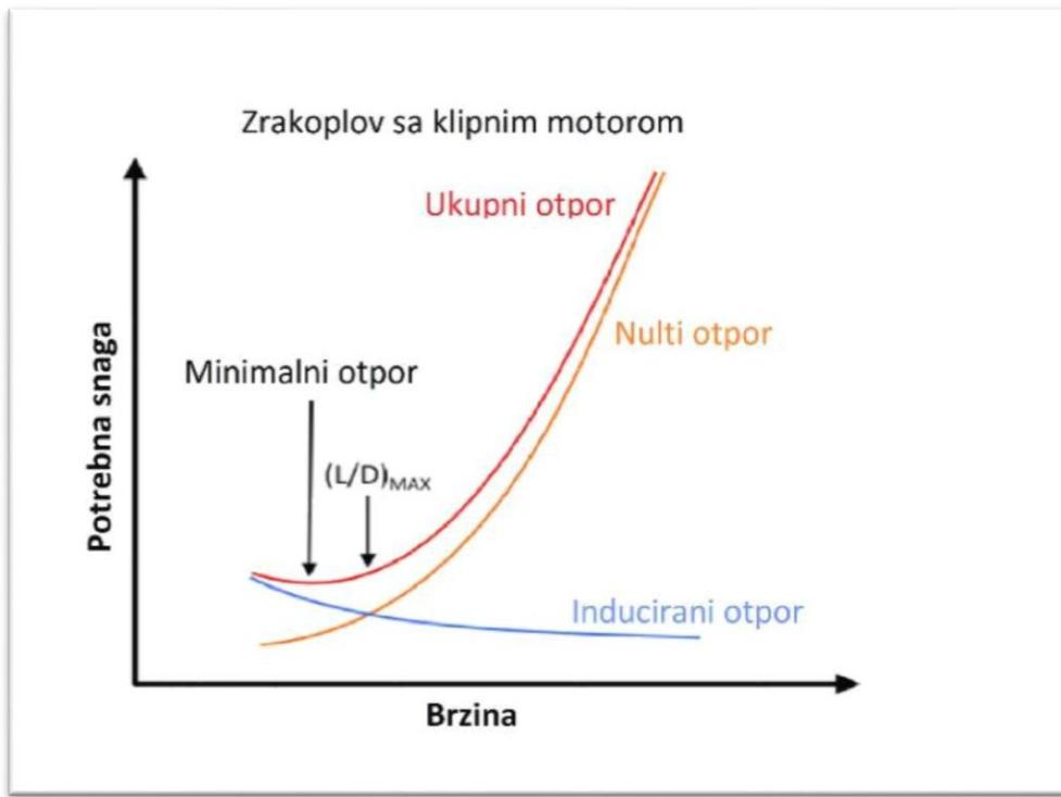
Slika 3 Graf potrebne snage u ovisnosti o brzini [4]
