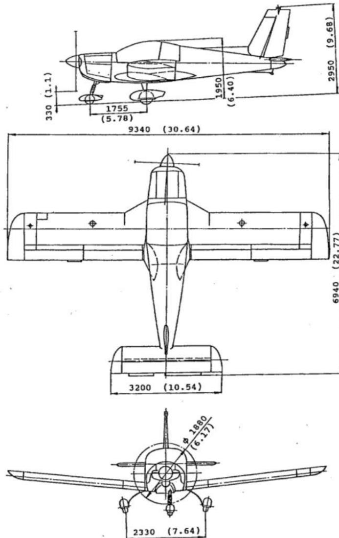
*Slika 1 Dimenzije zrakoplova [1]*
