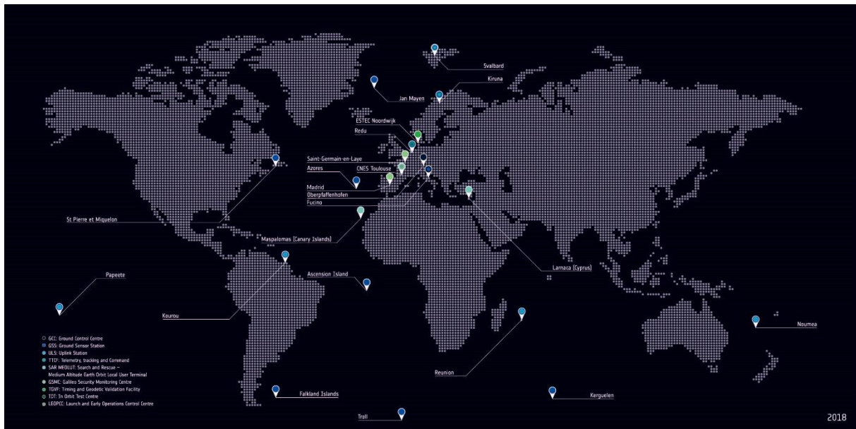
Slika 7. Zemaljski segment Galileo sustava
