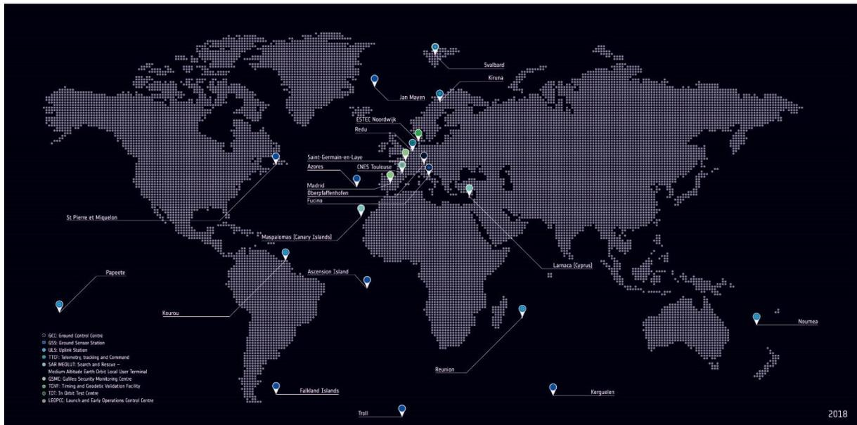
Slika 7. Zemaljski segment Galileo sustava
