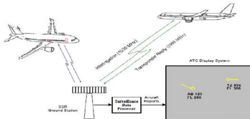
Slika 2. Sekundarni nadzorni radar[7]
