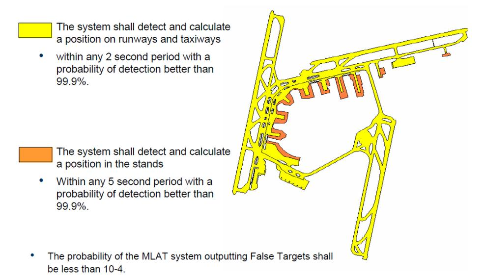
**Slika 7.** Zahtjev točnosti na površinama zračne luke [10]
