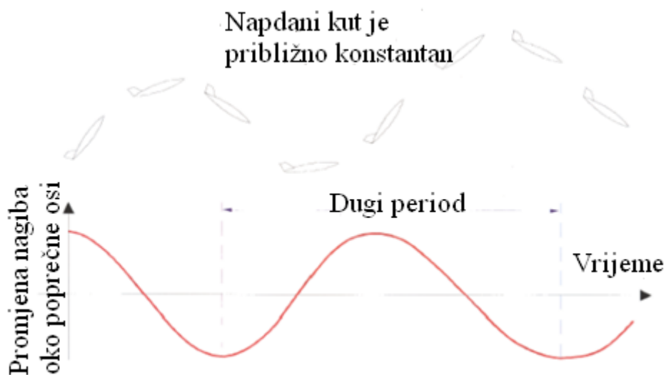
Slika 9. Dugoperiodični mod., ovisnost nagiba oko poprečne osi i vremena pri približno konstantnom napadnom kutu [2]
