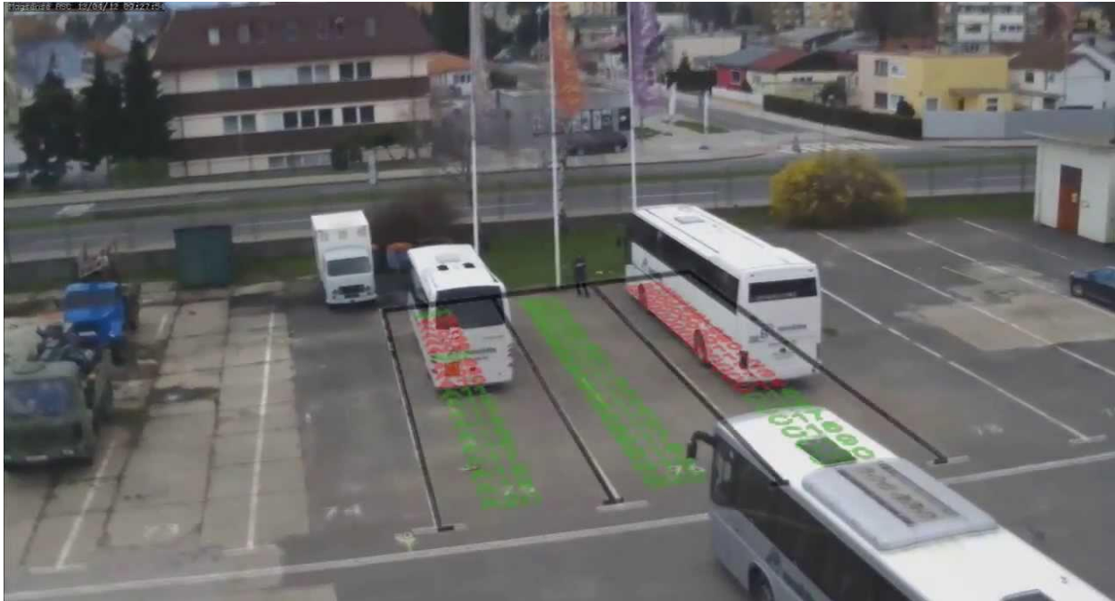
Slika 7: Magsense detektor u funkciji pomoći pri parkiranju
