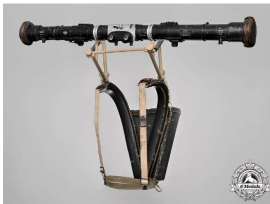
Slika 4 Primjer stereoskopskog daljinomjera [2]
