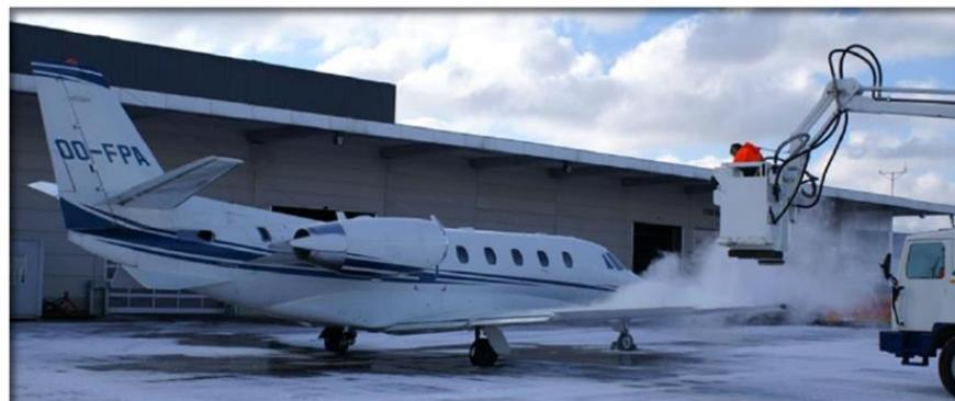
**Slika 8.** Postupak odleđivanja zrakoplova
