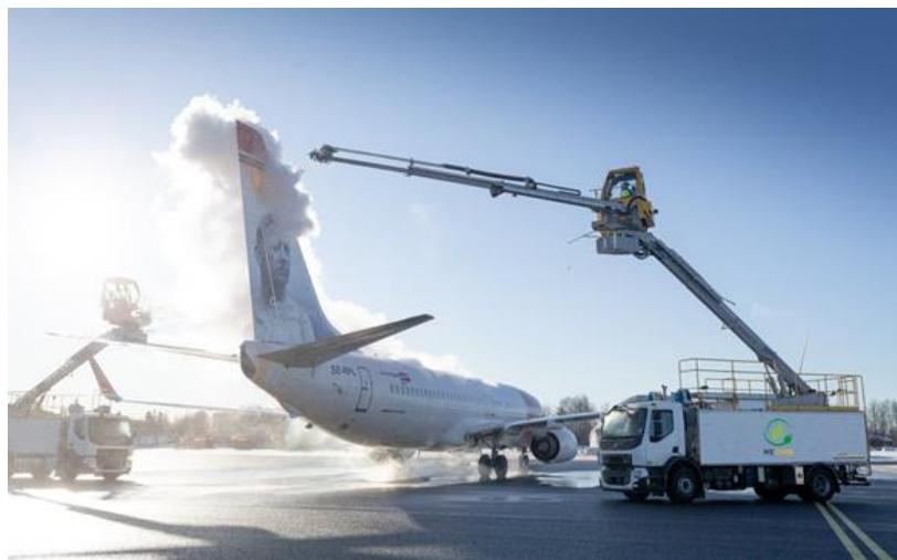
**Slika 20.** Električni odleđivač *Elephant e-BETA* u zračnoj luci Helsinki
