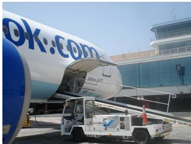
**Slika 5.** Istovar prtljage pomoću mobilne tekuće trake
