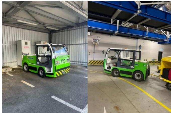
**Slika 15.** Električni tegljač za prtljagu TLD JET 16 na Zračnoj luci Franjo Tuđman
