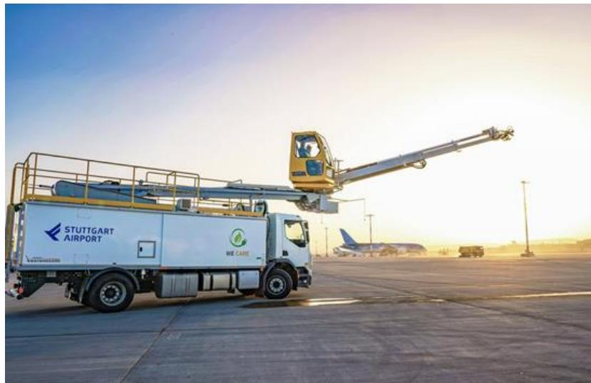
**Slika 21.** Odleđivač *Elephant e-BETA* u Zračnoj luci u Stuttgartu
