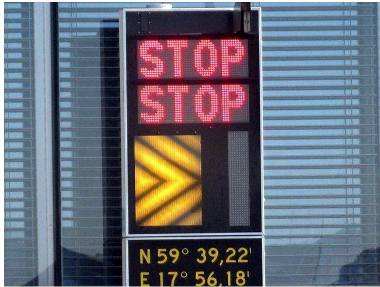
**Slika 3.** Prikaz vizualnog sustava navođenja zrakoplova na poziciju
