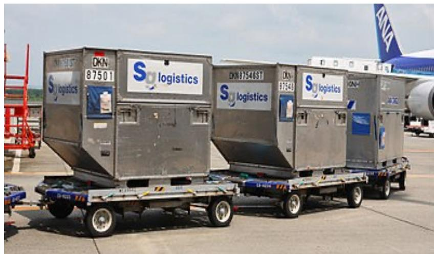
**Slika 10.** Prikaz zrakoplovnog kontejnera
