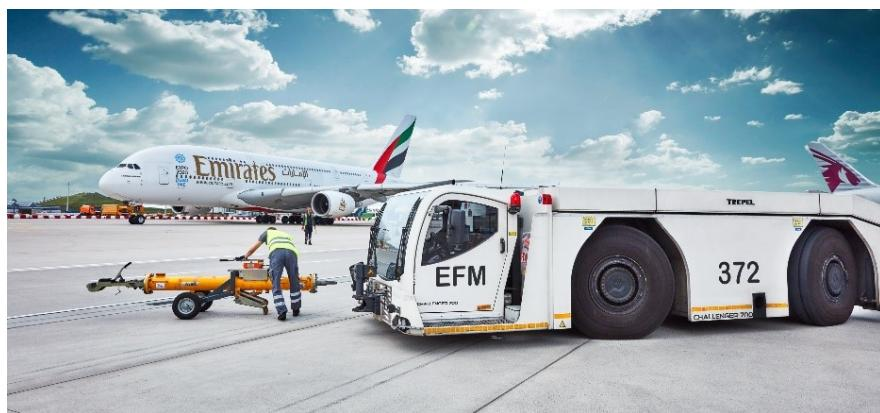
**Slika 16.**Traktor za izguravanje zrakoplova s pozicije
