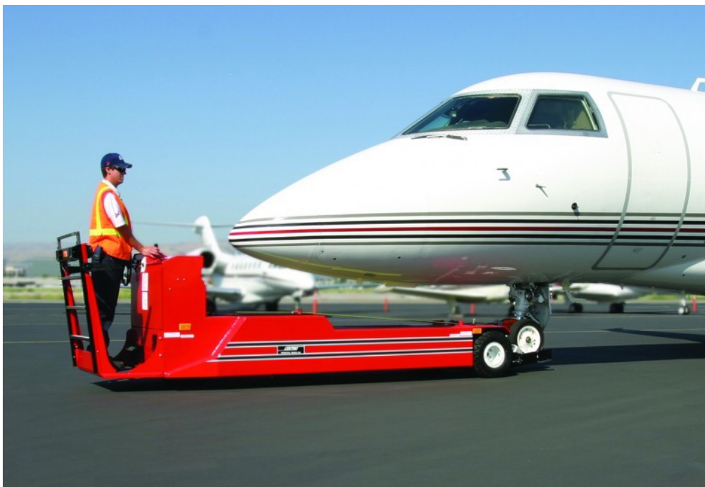
Slika 23. Prikaz LEKTRO tegljača
