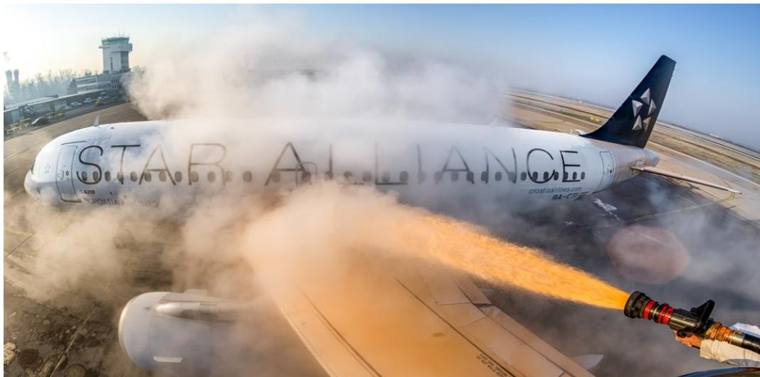
**Slika 12.** Prikaz odleđivanja zrakoplova
