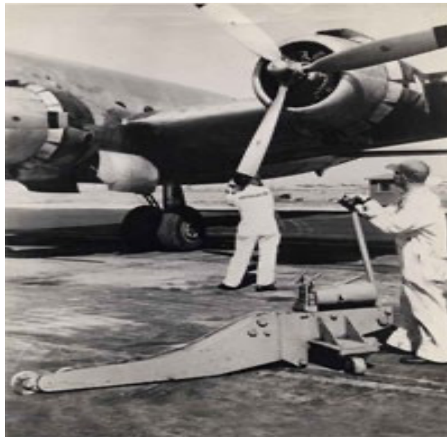
Slika 17. Dizalica za zrakoplove
