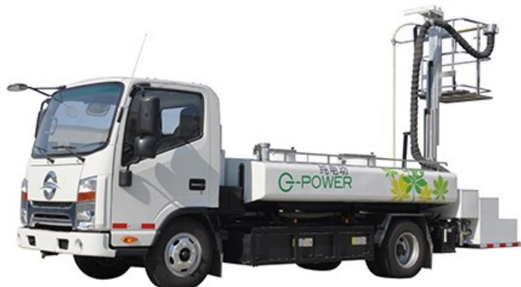
**Slika 34.** Vozilo za pražnjenje fekalija iz zrakoplova
