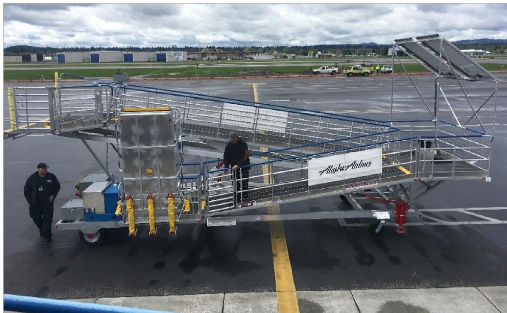
**Slika 30.** Električno - hidraulična platforma
