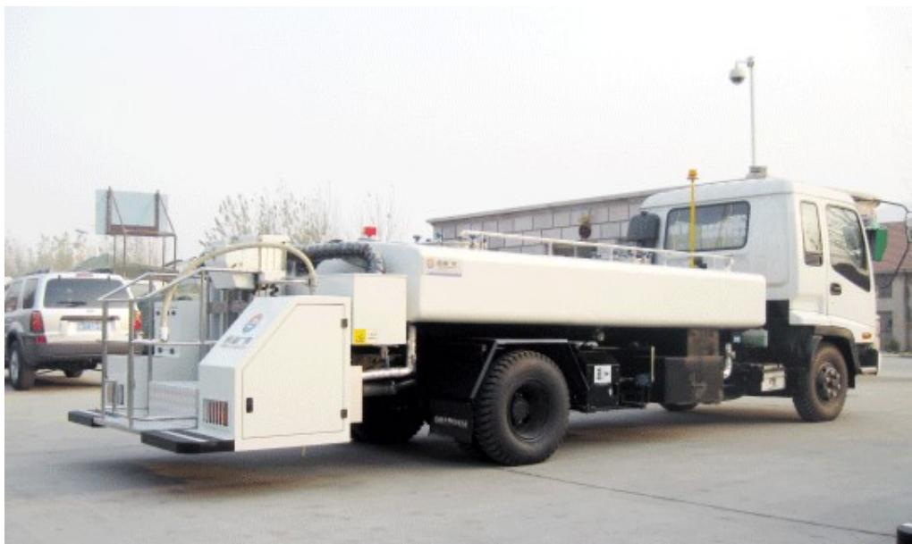
**Slika 33.** Vozilo za opskrbu zrakoplova pitkom vodom
