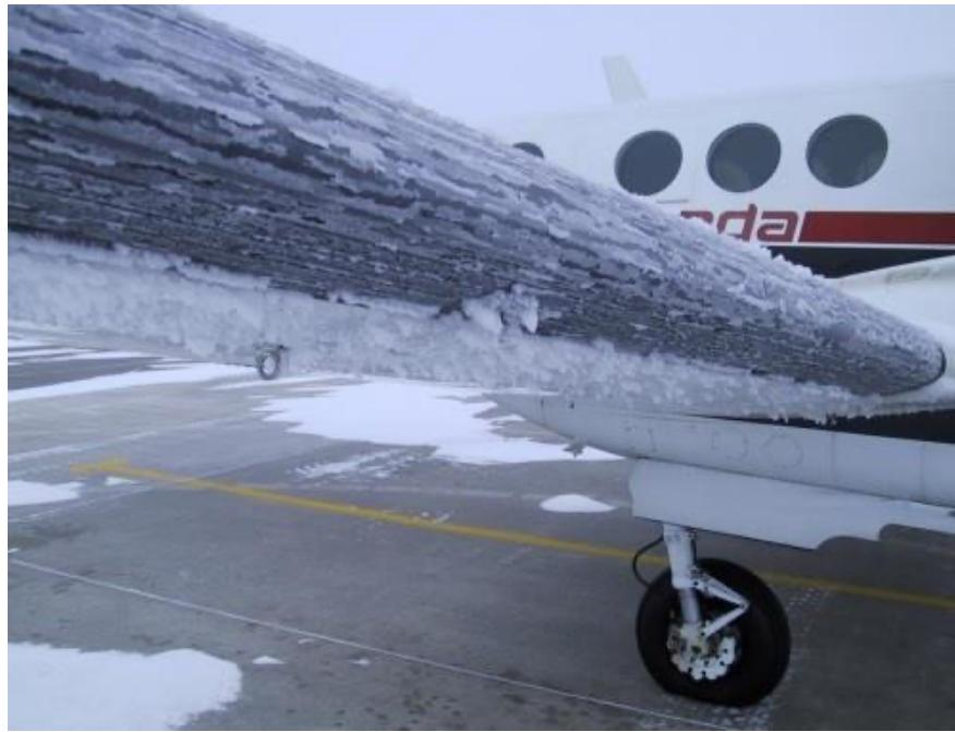
**Slika 11.** Prikaz kontaminata na aerodinamičkoj površini
