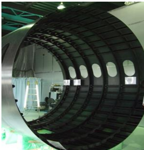
Slika 18. Trup zrakoplova izrađen kompozitnih materijala
