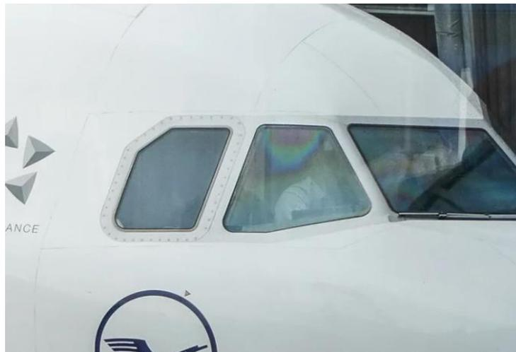
**Slika 13.** Prozori na zrakoplovu izrađeni od pleksi stakla
