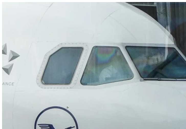
Slika 13. Prozori na zrakoplovu izrađeni od pleksi stakla
