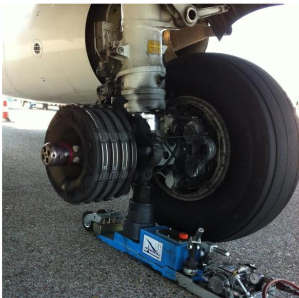
**Slika 10.** Prikaz kočnica zrakoplova
