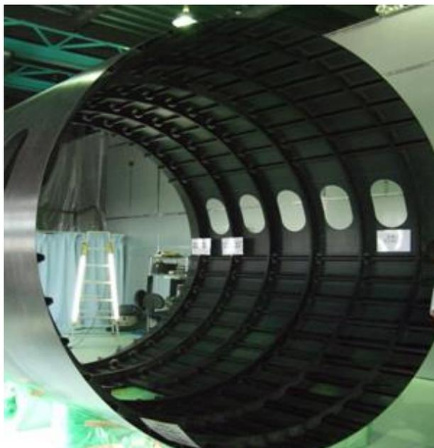
**Slika 18.** Trup zrakoplova izrađen kompozitnih materijala
