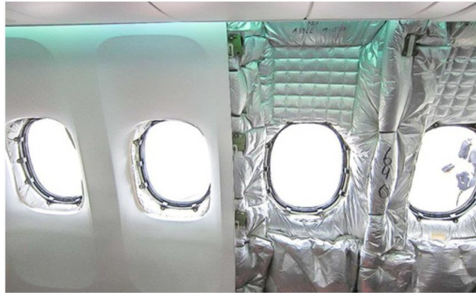
Slika 15. Prikaz izolacije zidova zrakoplova stiroporom
