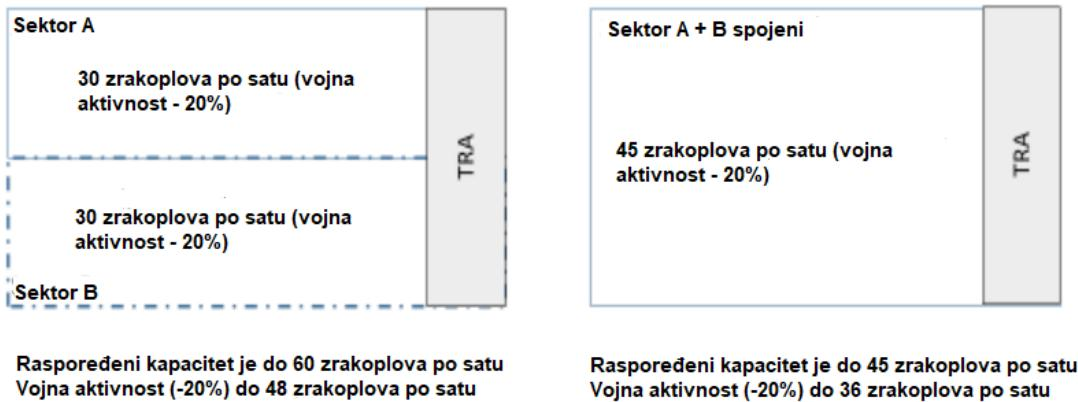
**Slika 24.** Prikaz potencijalne razlike kapaciteta za isti volumen zračnog prostora
