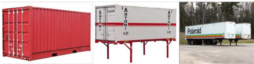
Slika 8 Osnovne intermodalne transportne jedinice
