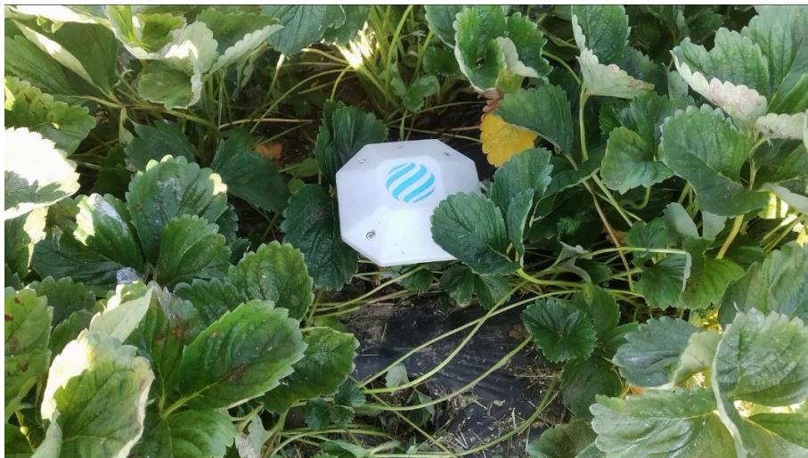
Slika 23. RSMT3L senzor vlage i temperature
