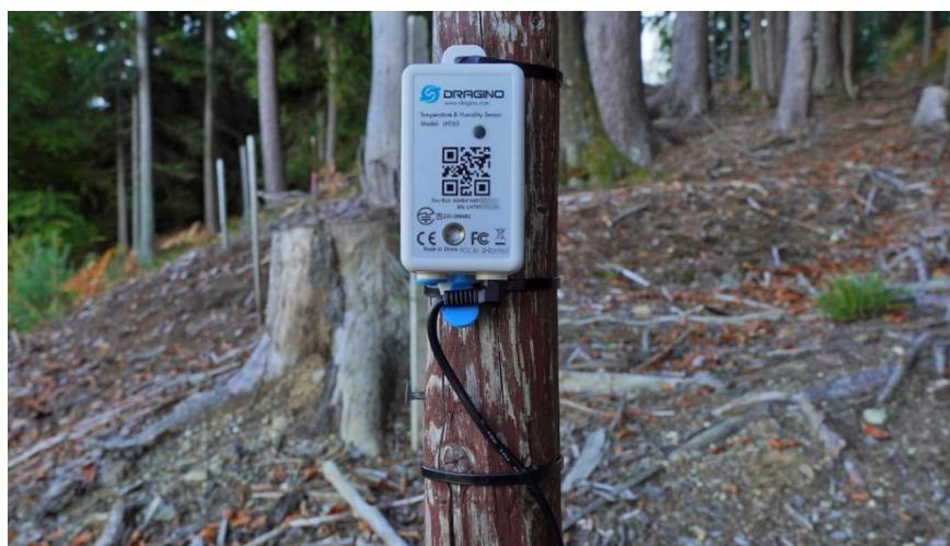
Slika 22. Dragino LHT65 senzor temperature i vlage
