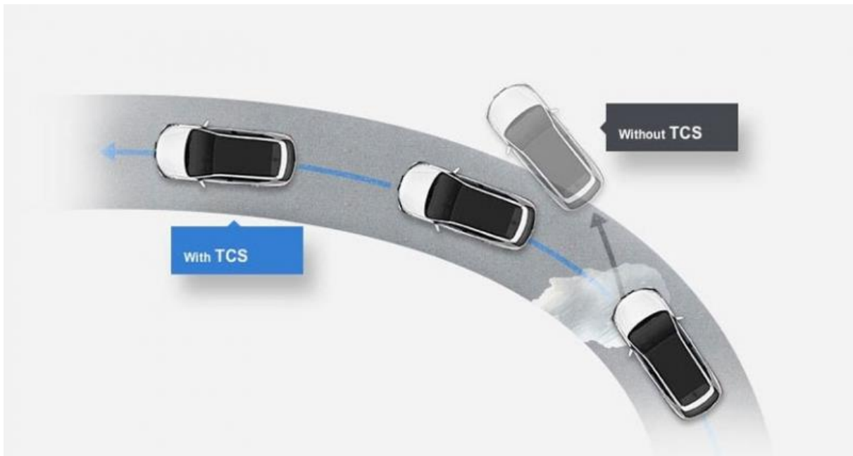
Slika 10. Kretanje vozila s i bez TCS-a [18]
