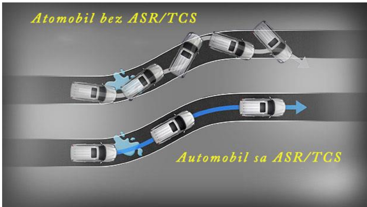
Slika 5. Kretanje vozila s i bez TRC-a u lošim vremenskim uvjetima [44]
