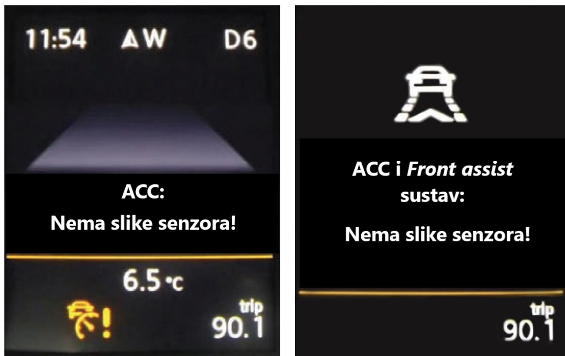
Slika 10. Radna ograničenja Adaptive Cruise Control sustava [20]
