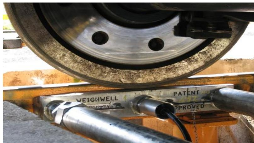
*Slika 12. Mjerenje mase i osovinskih pritisaka*
