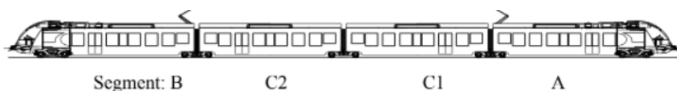
Slika 5. Konfiguracija elektromotornog vlaka 6112
