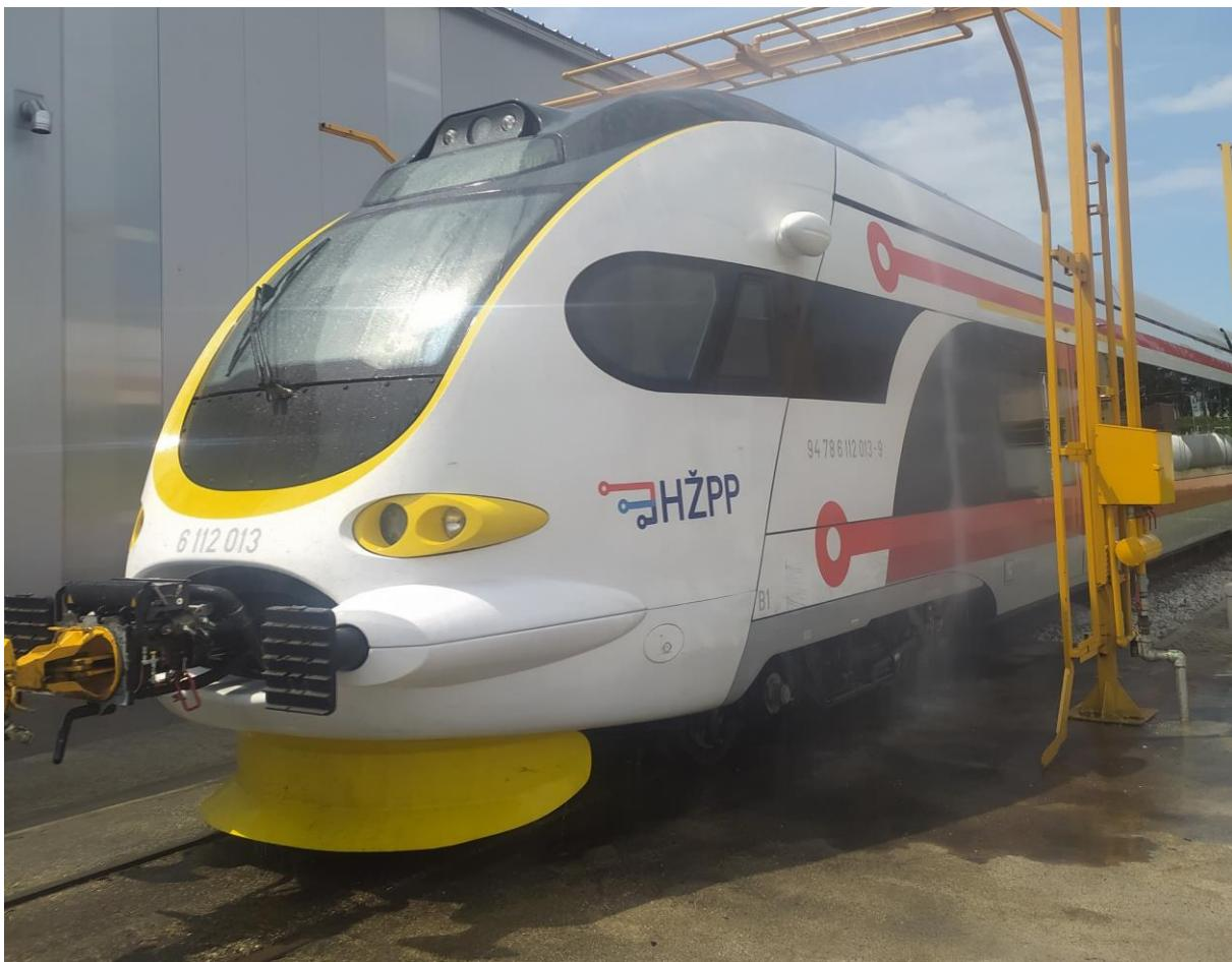
*Slika 13. Ispitivanje vodonepropusnosti na umjetnoj kiši EMV-a 6112*
