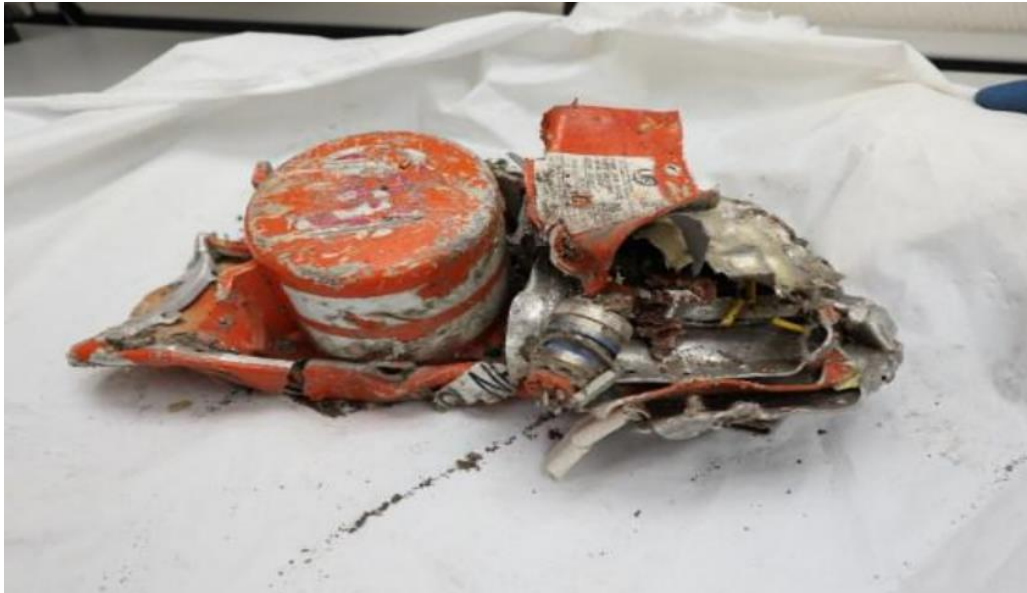
Slika 18. Snimač podataka o letu zrakoplova ET-AVJ, [47]
