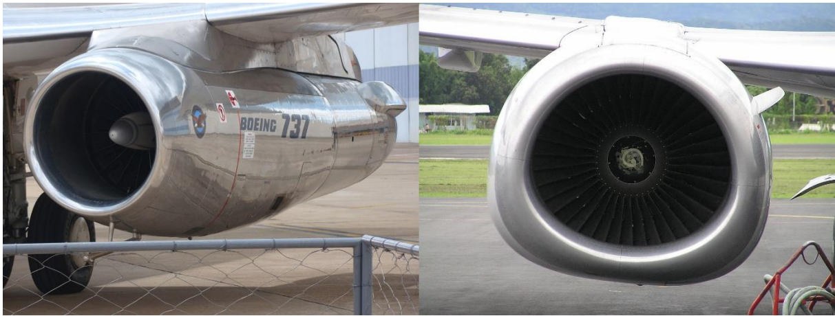
Slika 4. Razlika između gondole Boeinga 737-200 (lijevo) i 737-300 (desno), [11], [12]
