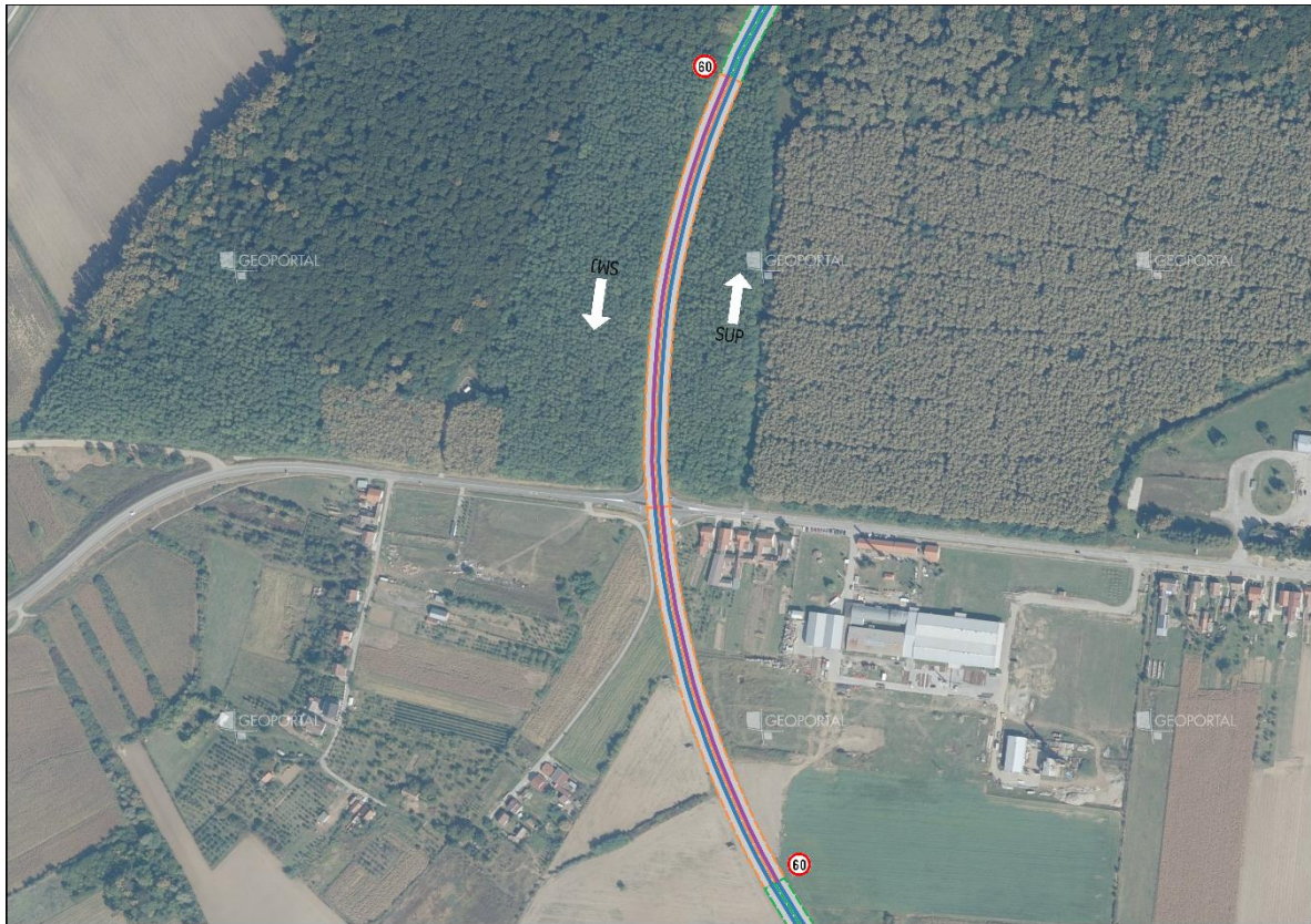
Slika 4. Četvrti primjer neusklađenosti ograničenja brzine na državnoj cesti DC7
