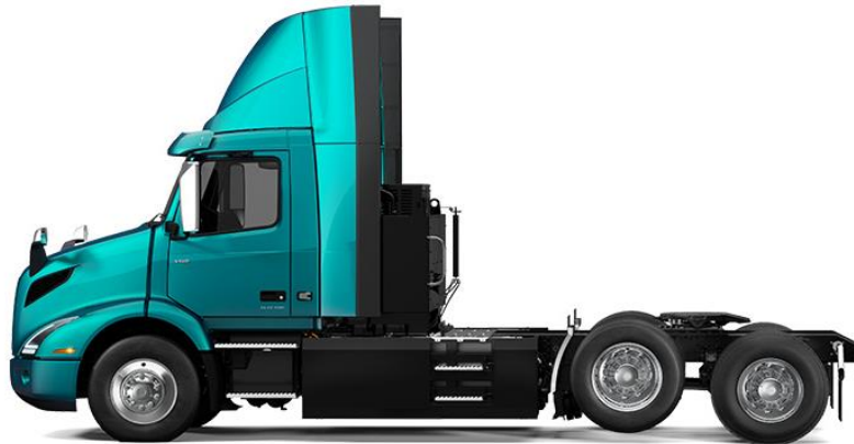
Slika 29. Volvo VNR tegljač s pogonom 6x2
