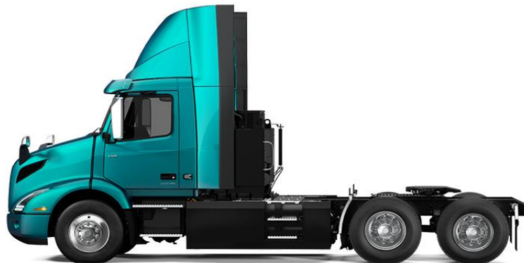
Slika 30. Volvo VNR tegljač s pogonom 6x4
