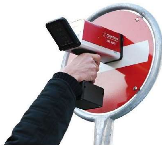
Slika 22. Retroreflektrometar Zehntner ZRS 6060
