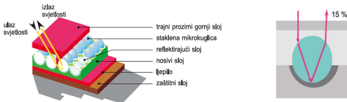
Slika 18. Retroreflektirajući materijal klase II
