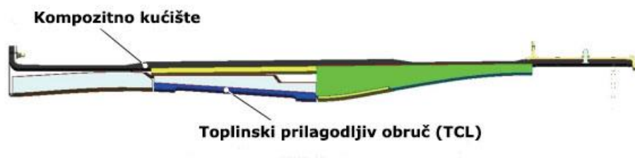
Slika 11. Presjek kompozitnog kućišta ventilatora, [19]
