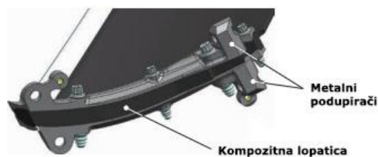
Slika 12. Struktura kompozitnih izlaznih vodilica ventilatora, [19]
