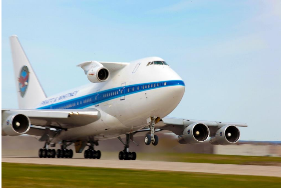
Slika 6. Boeing 747SP (Special Operations) kakav se koristio pri testiranju PW1000G motora, [14]
