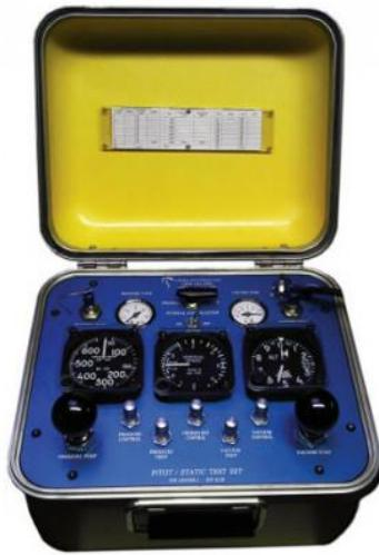
**Slika 6.** Oprema za testiranje pitot-statičkog sustava, AD450E-1,
