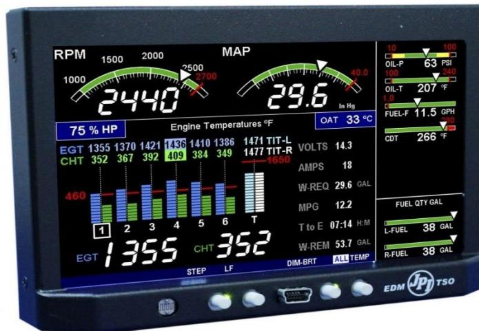
**Slika 13.** EDM 900 sustav za praćenje parametara motora, [21]
