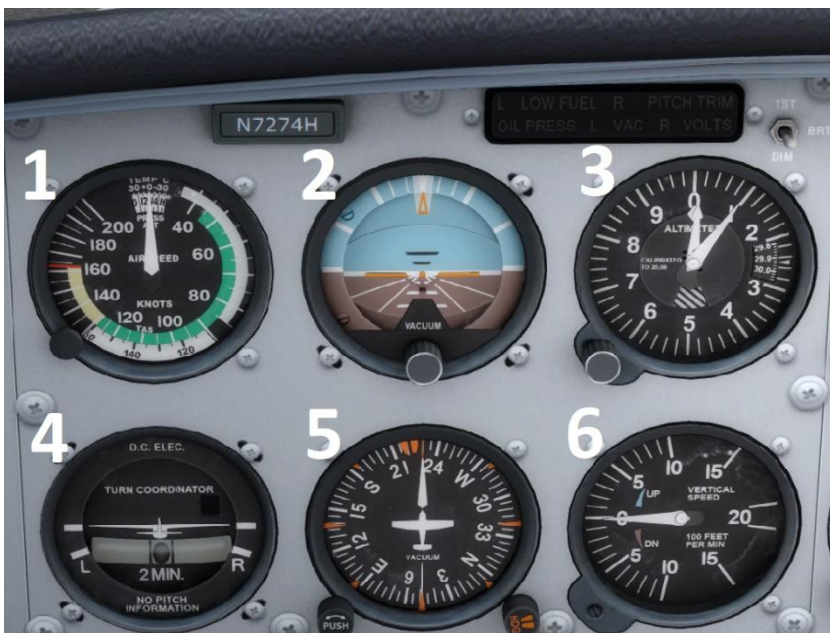
Slika 2. Osnovnih šest instrumenata, [9]
