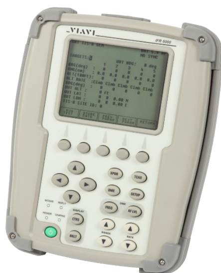
Slika 7. Viavi IFR 6000 oprema za testiranje transpondera, [18]
