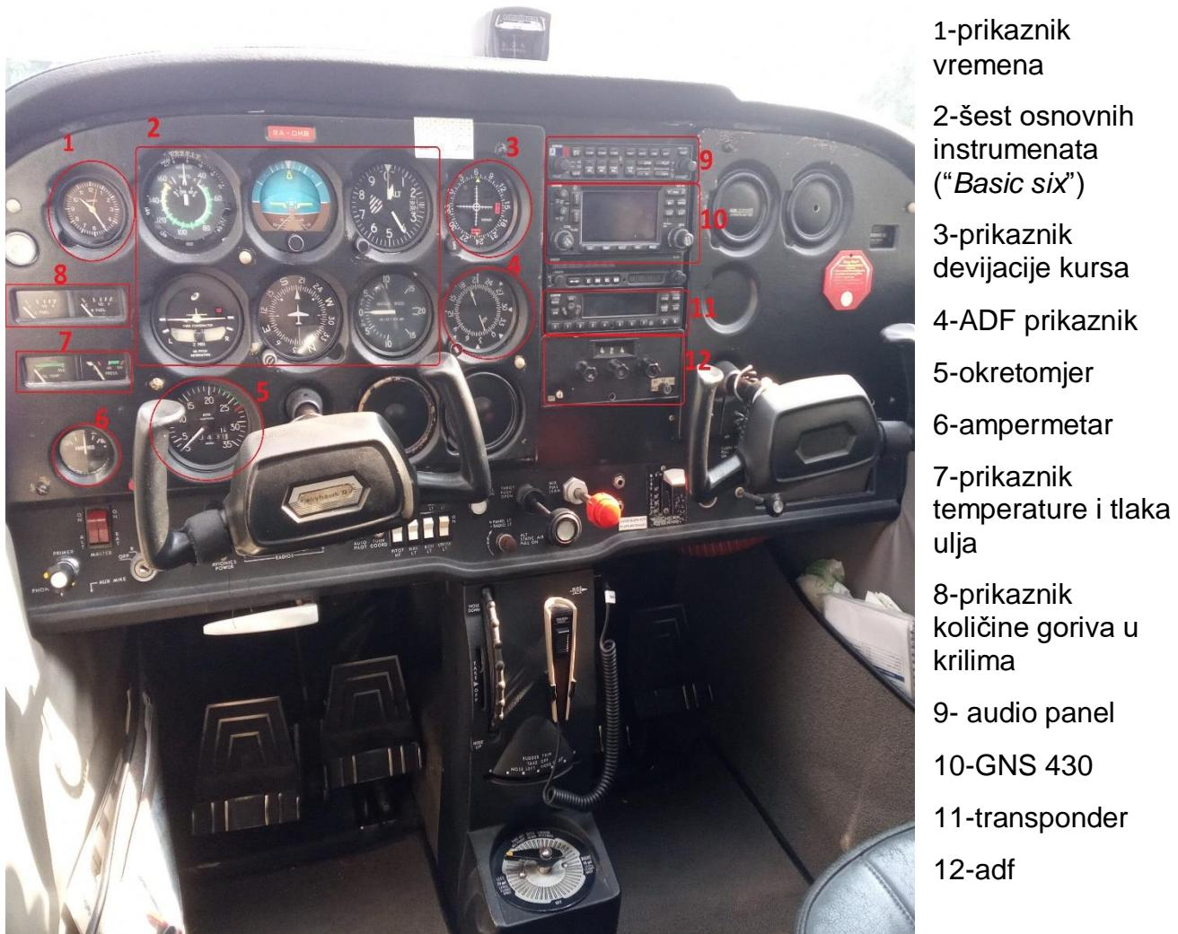
Slika 9. Izgled instrument ploče prije modifikacije, [14]
