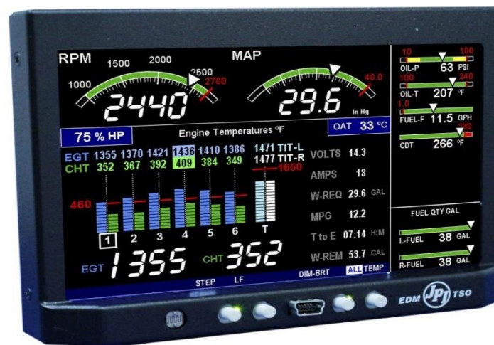
Slika 13. EDM 900 sustav za praćenje parametara motora, [21]
